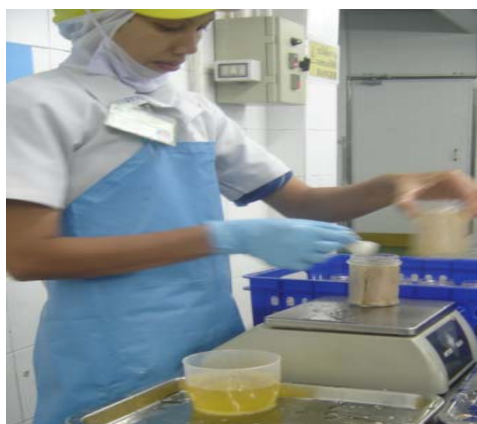
ภาพที่ 8. วิธีการปรับน้ำหนักสุทธิผลิตภัณฑ์ปลาทูน่าบรรจุขวดแก้ว
