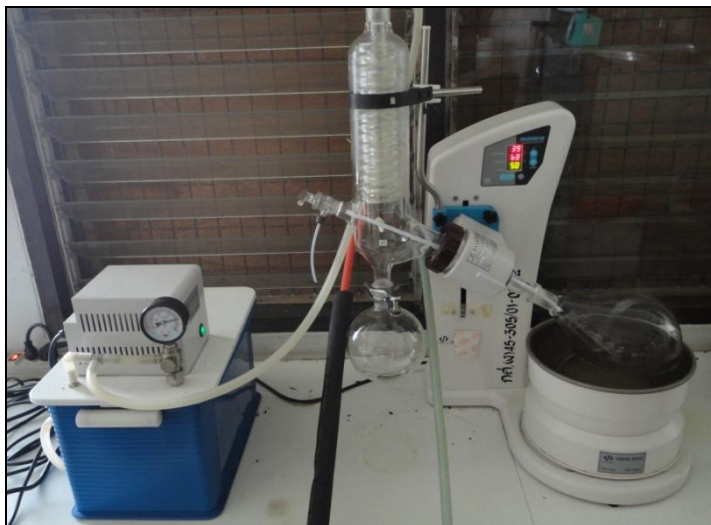
ภาพที่ 16 เครื่องระเหยสุญญากาศแบบหมุนเพื่อระเหยตัวทำละลายออก
