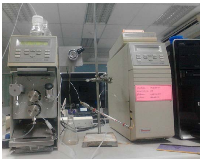
ภาพที่ 20 ชุดเครื่องวิเคราะห์และแยกสารของเหลวสมรรถนะสูง (HPLC)
