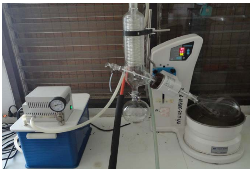
ภาพที่ 15 เครื่องระเหยสุญญากาศแบบหมุน (rotary evaporator)
