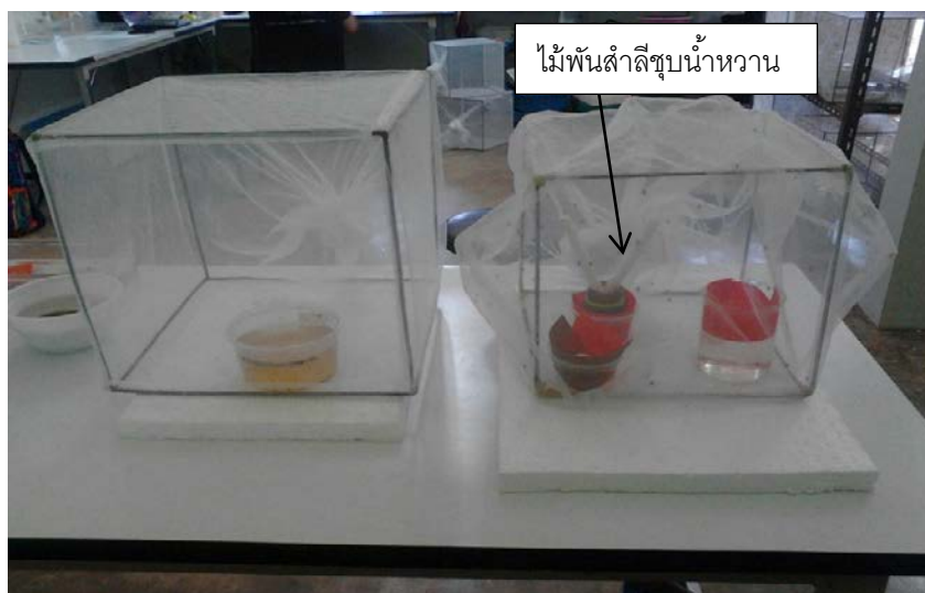
ภาพที่ 11 กรงเลี้ยงยุงขนาด 30 × 30 × 30 เซนติเมตร และ สำลีพันไม้ชุบน้ำหวาน
