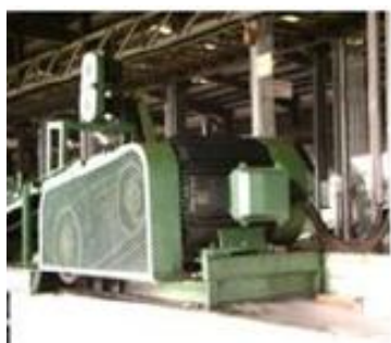
G. เครื่องตัดย่อยยางและตัดฝอย (Sherdder)
