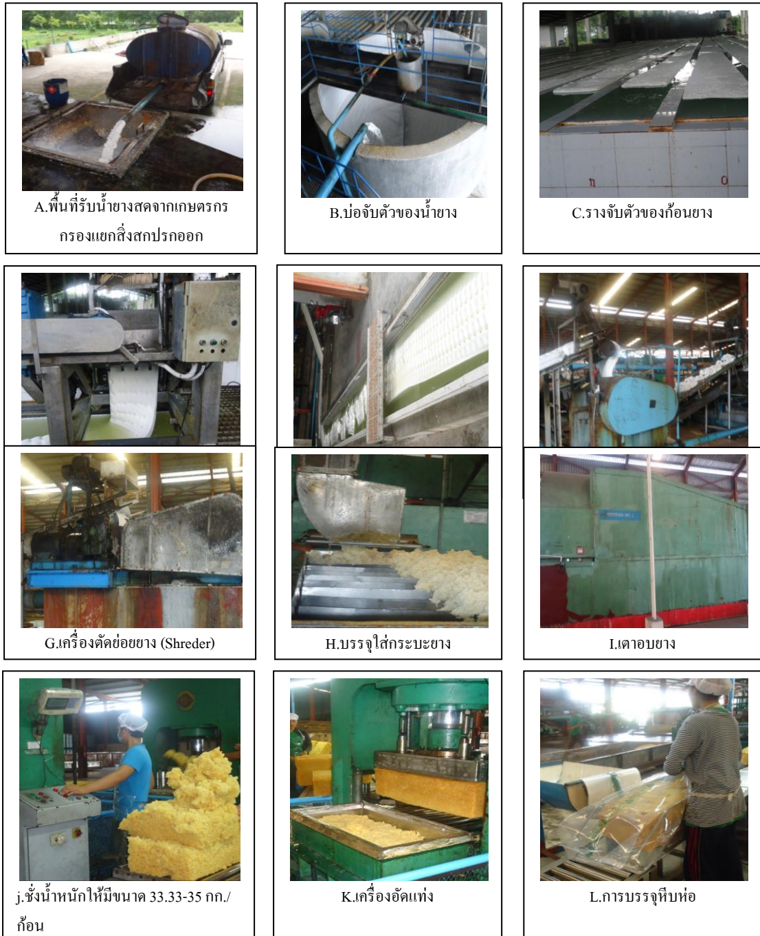
ภาพภาคผนวก ฉ-1 การศึกษาดูกระบวนการผลิตยางแท่งจากน้ำยางสด (STR 5L)
