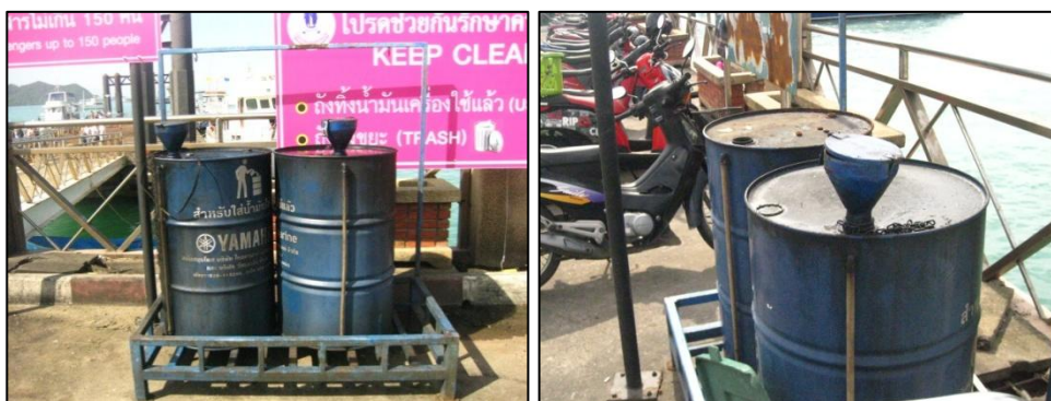
รูปที่ 4.11 ถังใส่น้ำมันเครื่องใช้แล้ว ขนาด 200 ลิตร จำนวน 4 ใบ บนสะพานท่าเทียบเรืออ่าวคลอง
