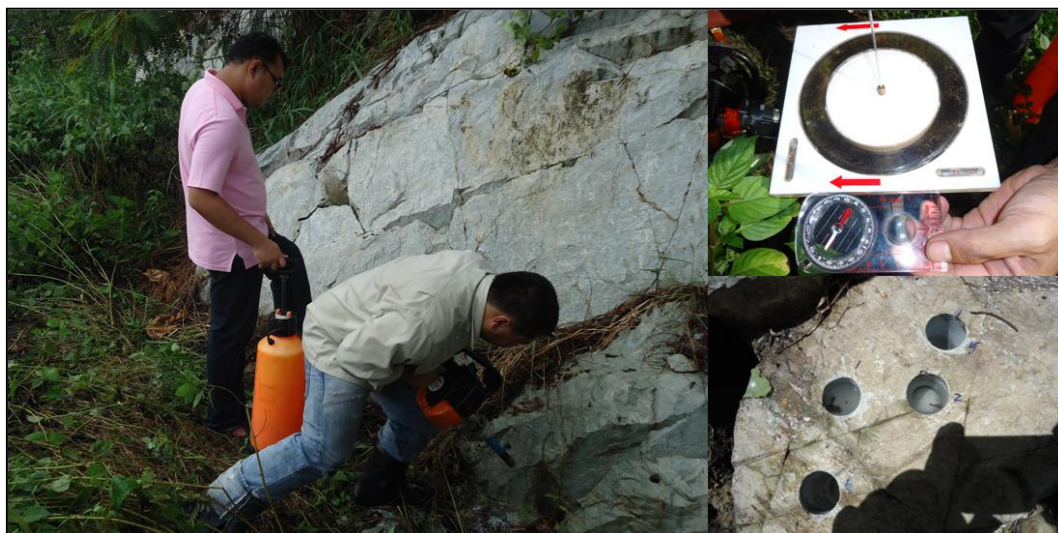
ภาพประกอบที่ 2.12 ขั้นตอนการเก็บตัวอย่างหินด้วยเครื่องเจาะแบบเก็บแกน ชนิดวัดการวางตัว, การวัดค่ามุม Dip และ มุม Strike
