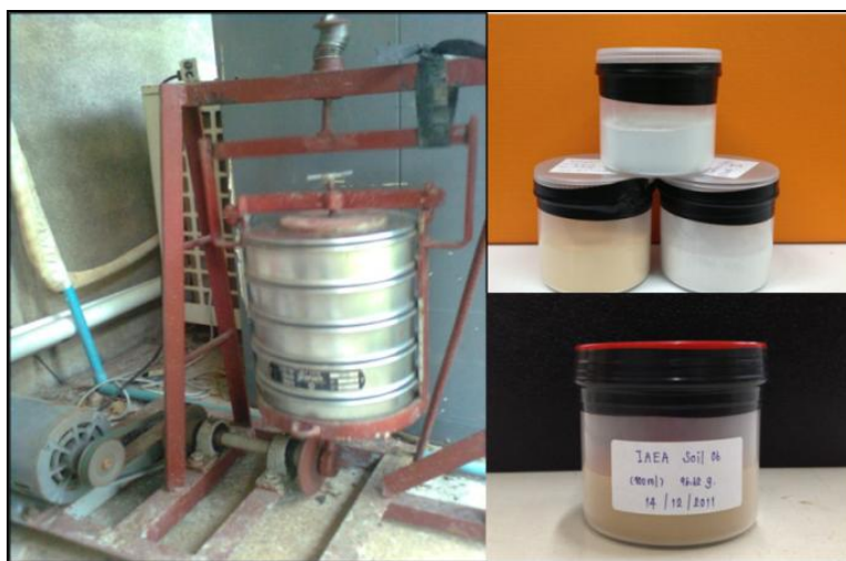
ภาพประกอบที่ 2.15 เครื่องร่อนแยกหินและดิน สารมาตรฐาน IAEA Soil 6 และ ตัวอย่างหินที่ผ่านการอบความร้อนและบดละเอียดด้วยเครื่อง Ball mill
