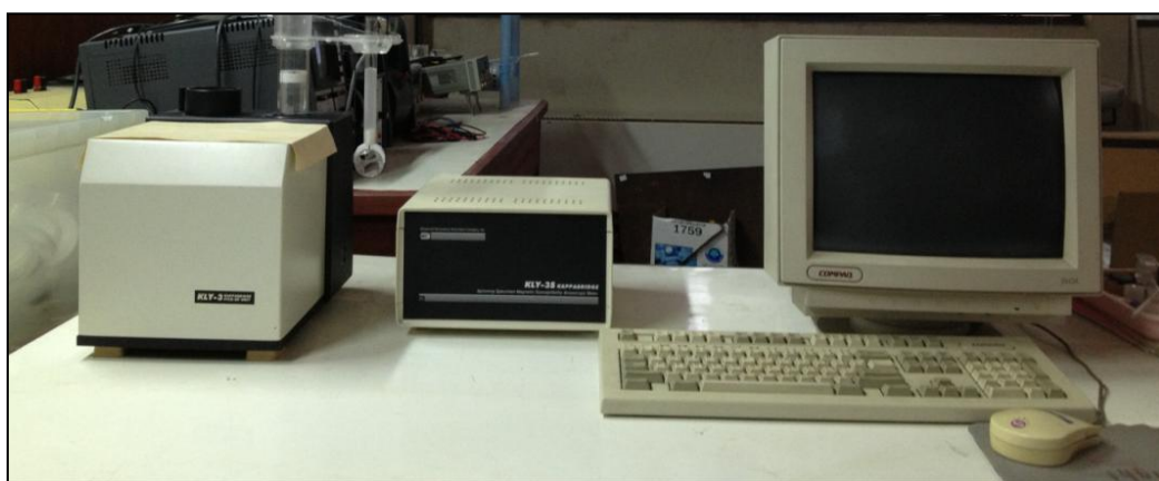
ภาพประกอบที่ 2.13 เครื่องวัดสภาพรับไว้ได้ทางแม่เหล็ก ยี่ห้อ AGICO รุ่น KLY-3S Kappabridges ประเทศสาธารณรัฐเชค
