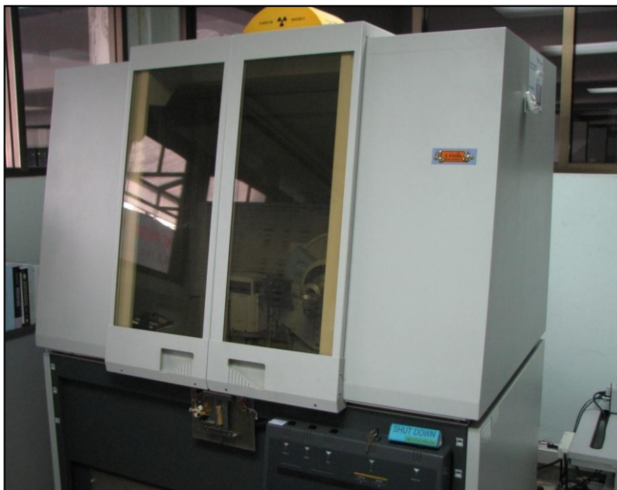
ภาพประกอบที่ 2.14 เครื่อง X-Ray Diffractometer ณ ศูนย์เครื่องมือทางวิทยาศาสตร์ มหาวิทยาลัยสงขลานครินทร์ วิทยาเขตหาดใหญ่
