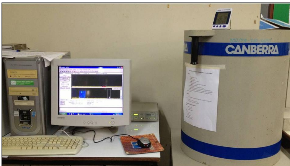
ภาพประกอบที่ 2.16 เครื่องสเปกโตรมิเตอร์รังสีแกมมา (Gamma Ray Spectrometer) หัววัดแบบ HPGe ชนิด NaI
