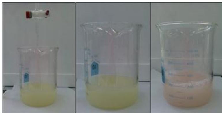
ภาพประกอบที่ 3-17 การวิเคราะห์ความเข้มข้นของแอมโมเนียในหางน้ำยางด้วยวิธีการไทเทรต
