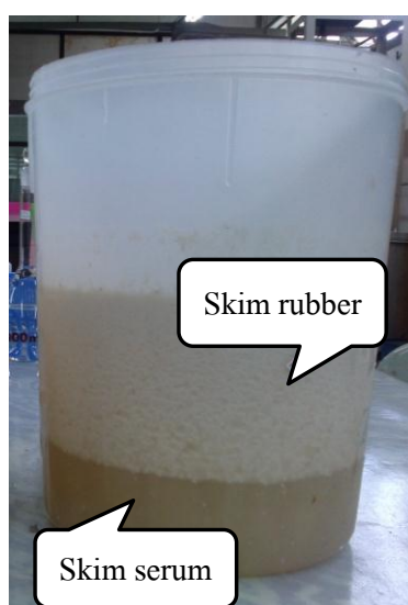
ภาพประกอบที่ 3-23 การแยกตัวของยางสกิมกับน้ำซีรัมหลังกระบวนการจับตัวเนื้อยาง
