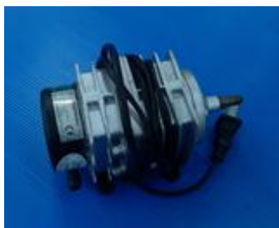
ภาพประกอบที่ 3-19 ปั๊มเก็บตัวอย่างอากาศเสียเพื่อวัดความเข้มข้นของแอมโมเนียในอากาศ
