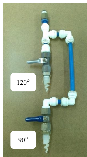
ภาพประกอบที่ 4-8 การต่อหัวสเปรย์ 2 หัว แบบขนานบน-ล่าง
