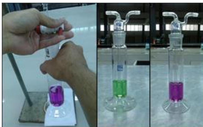
ภาพประกอบที่ 3-21 การวิเคราะห์ความเข้มข้นของแอมโมเนียในอากาศเสียด้วยวิธีการไทเทรต
