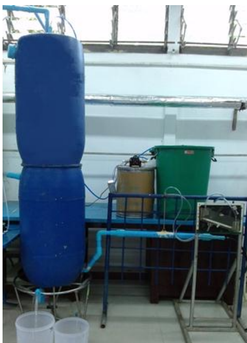
ภาพประกอบที่ 3-11 ระบบการดำเนินงานของคอลัมน์สเปรย์สูง 2 เมตร
