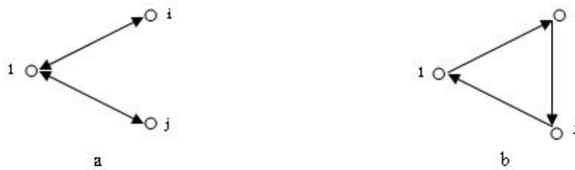
ภาพที่ 5 a เส้นทางรถแบบเดิม และ b เส้นทางรถแบบเซฟวิ่ง
