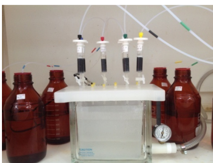
ภาพที่ 3-5 อุปกรณ์ชุดสกัด Solid phase extraction (SPE)
