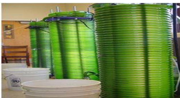
รูปที่ 2.5 การเลี้ยงสาหร่ายเพื่อเปลี่ยนก๊าซคาร์บอนไดออกไซด์เป็นพลังงาน [27]
