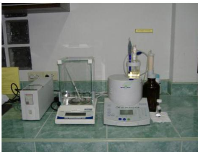
ภาพประกอบที่ 4 เครื่อง Karl Fisher coulometer ของบริษัท Mettler รุ่น DL39 หลักการของเครื่อง
