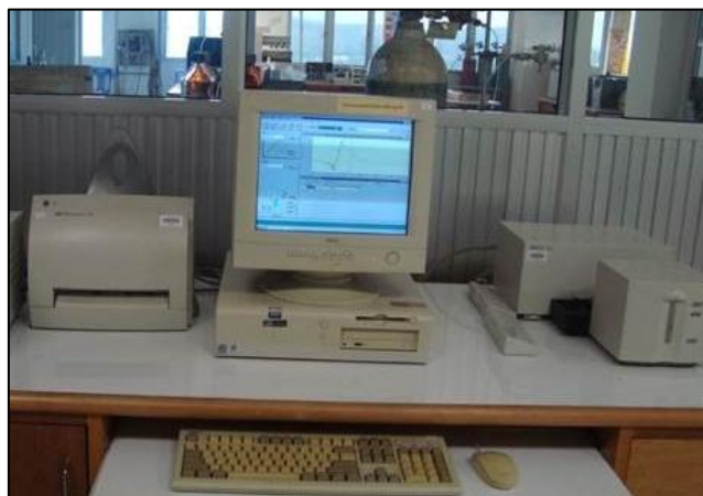
ภาพประกอบที่ 3-3 เครื่อง UV-Visible Spectrophotometer รุ่น HP 8453
