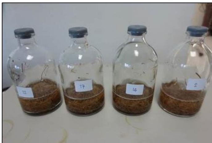
ภาพประกอบที่ 3-8 ขวดตัวอย่างการย่อยเส้นใยปาล์ม (ขนาดขวดตัวอย่าง 100 มิลลิตร)
