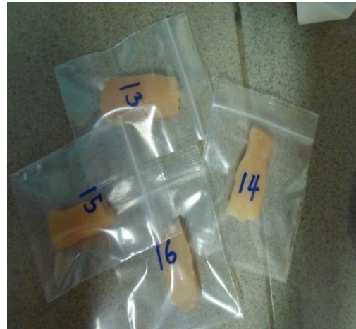
ภาพที่ 14 ลักษณะการเตรียมชิ้นเนื้อวิเคราะห์ Drip loss และ Cooking loss
