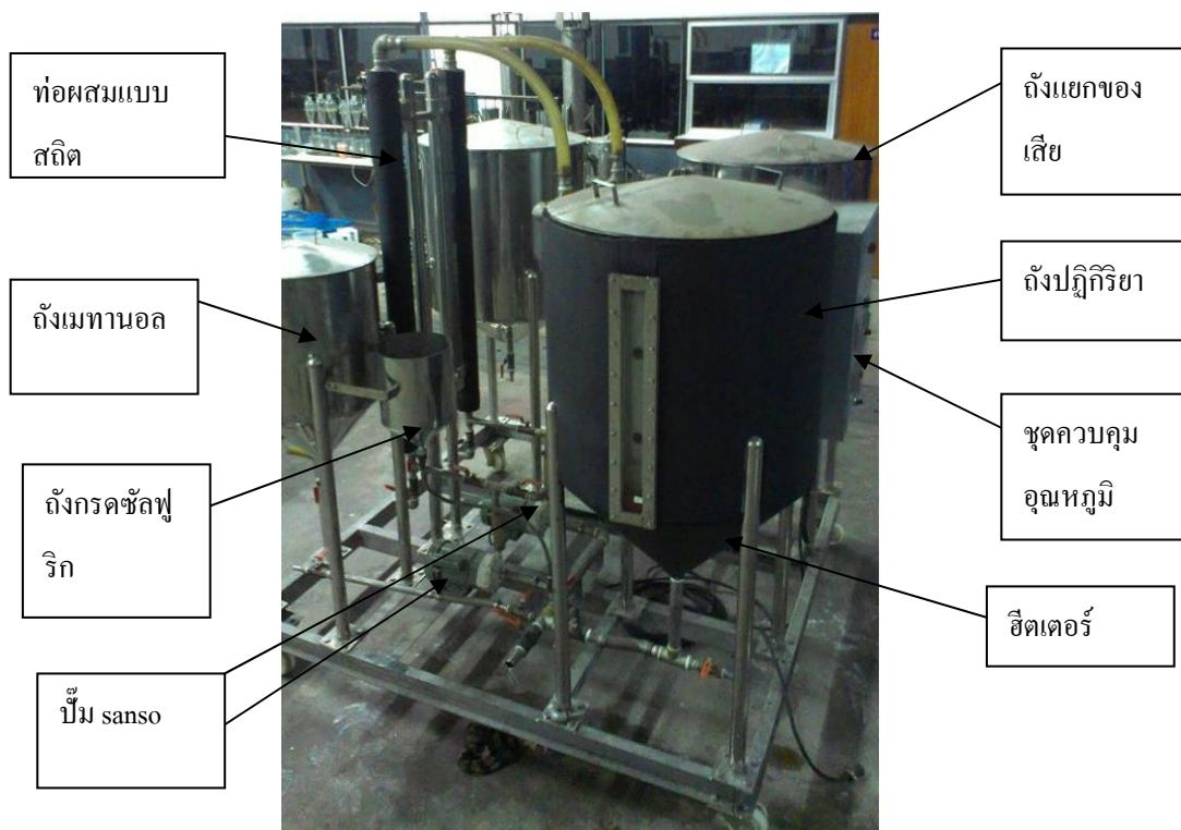
รูปที่ 4.3 ระบบลดกรดไขมันอิสระในน้ำมันปาล์มด้วยท่อผสมแบบสวิตช์หมุนวน
