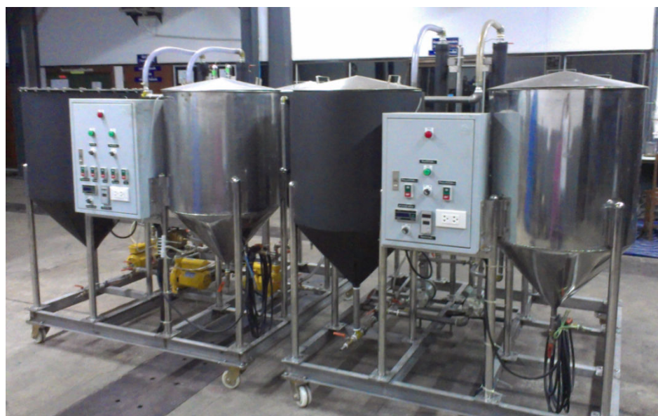
รูปที่ 5.6 แสดงระบบผลิตไบโอดีเซลแบบสองขั้นตอนจากน้ำมันปาล์มดิบชนิดกรดสูงด้วยท่อผสมแบบสถิตหมุนวน
