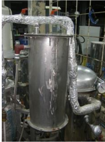
ภาพประกอบที่ 16 เครื่องควบแน่นที่ประกอบด้วยชุดสกัดแบบแบทช์
