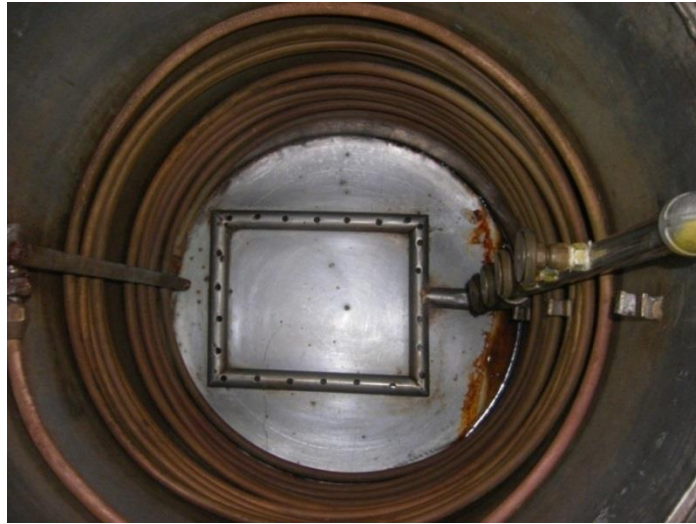
ภาพประกอบที่ 34 ด้านในของถังสกัดแบบเบทซ์หลังการปรับปรุง
