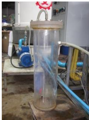
ภาพประกอบที่ 17 คอลัมน์ดักตัวทำละลายที่ประกอบด้วยชุดสกัดแบบแบทช์
