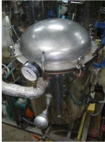
ภาพประกอบที่ 14 ถังระเหยขนาดใหญ่ที่ประกอบด้วยชุดสกัดแบบแบทช์
