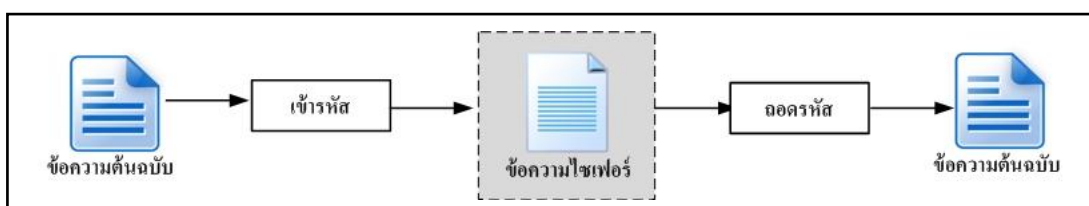
ภาพประกอบ 2.24 กระบวนการเข้ารหัสและถอดรหัสข้อความ
