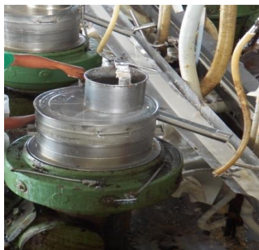
รูปที่ 2.1 วิธีปั่นแยกน้ำยางสดเป็นน้ำยางชั้น
