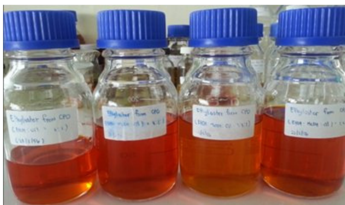
ภาพประกอบที่ 4-13 แสดงตัวอย่างน้ำมันเอทิลเอสเทอร์ที่อัตราส่วนระหว่าง EtOH : MeOH : Oil คือ (เรียงจากซ้ายไปขวา) 6:0:1, 4:2:1, 3:3:1 และ 2:4:1
