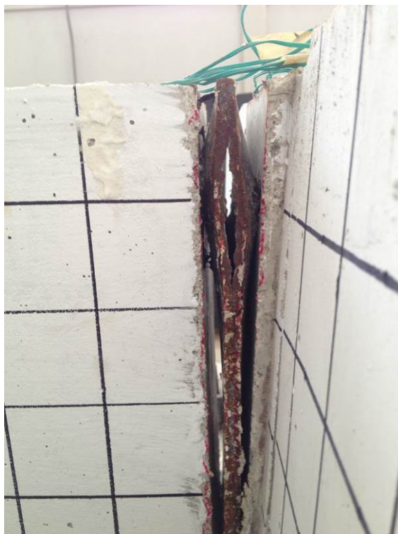
รูปที่ 2.22 การขาดของขอบเหล็กจากตัวอย่าง B2 16-4
