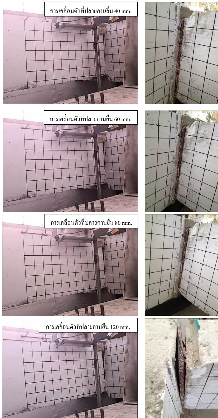
รูปที่ 2.18 ลักษณะการวิบัติของคานคอนกรีตที่มีรอยต่อแบบเพลาเหล็ก B1 12-6
