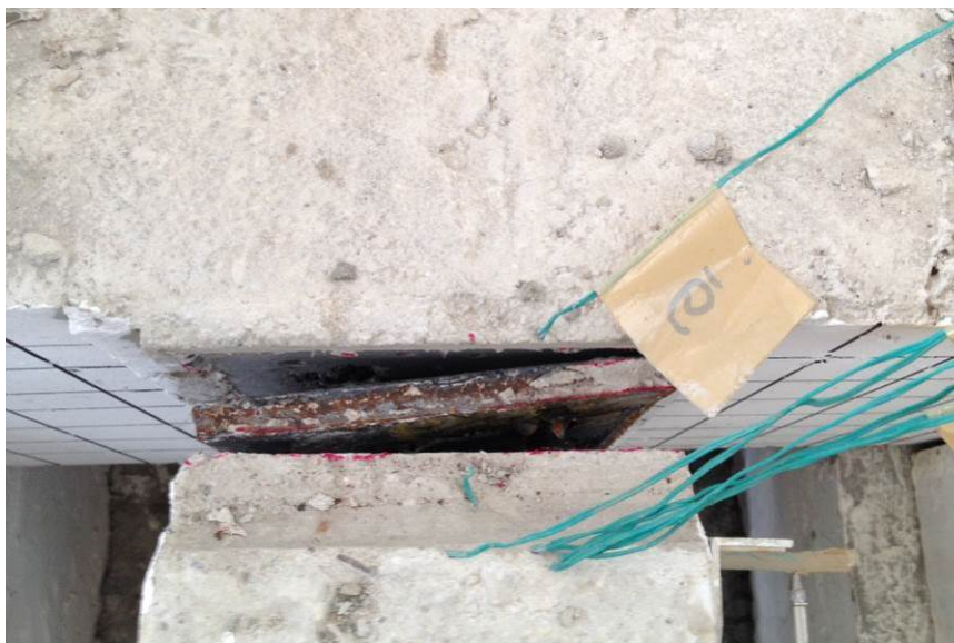
รูปที่ 2.23 การขาดของรอยเชื่อมบริเวณเหล็กเสริมจากตัวอย่าง B1 12-6
