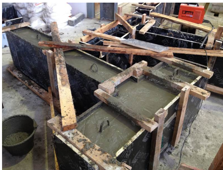
รูปที่ 2.7 การหล่อตัวอย่างทดสอบคานคอนกรีตหล่อเนื้อเดียว
