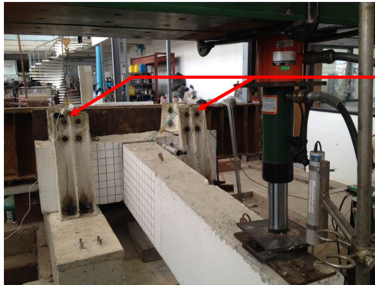
รูปที่ 2.12 การทดสอบคานคอนกรีตสำเร็จรูป
