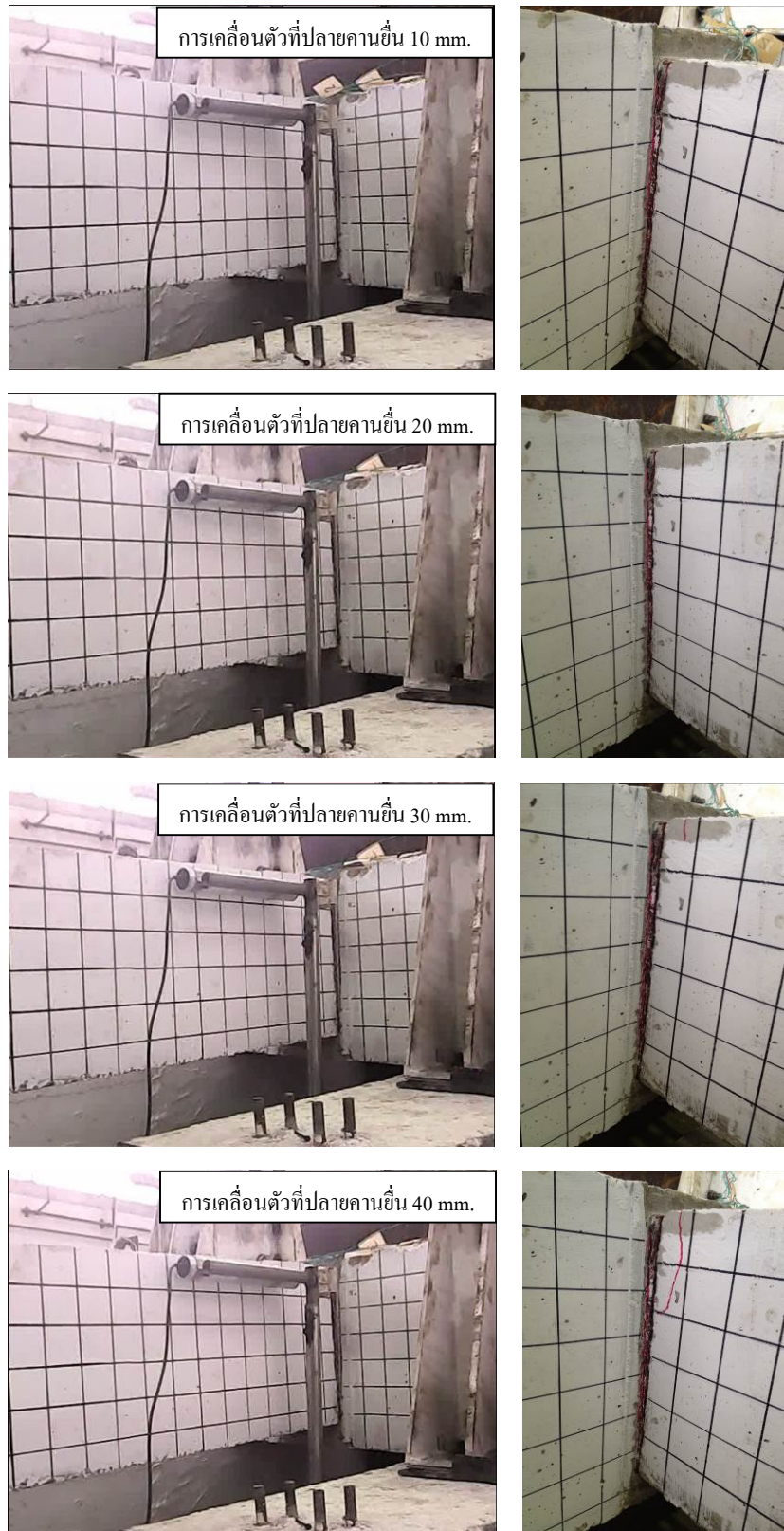
รูปที่ 2.16 ลักษณะการวิบัติของคานคอนกรีตที่มีรอยต่อแบบเพลาเหล็ก B1 9-4
