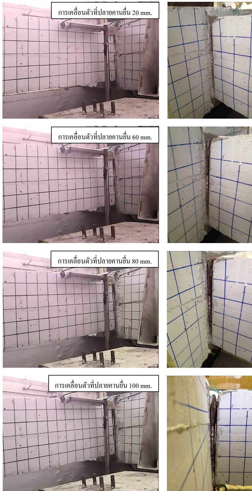
รูปที่ 2.17 ลักษณะการวิบัติของคานคอนกรีตที่มีรอยต่อแบบเพลาเหล็ก B1 12-4
