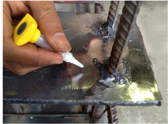
ทาขาวติดสำหรับ Strain gauge
