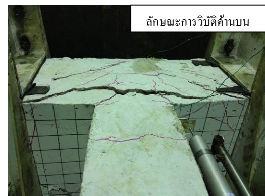
รูปที่ 2.15 ลักษณะการวิบัติของคานคอนกรีตหล่อเนื้อเดียว B2 16
