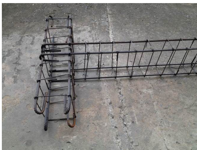
รูปที่ 2.5 ลักษณะเหล็กเสริมของตัวอย่างทดสอบคานคอนกรีตหล่อเนื้อเดียว
