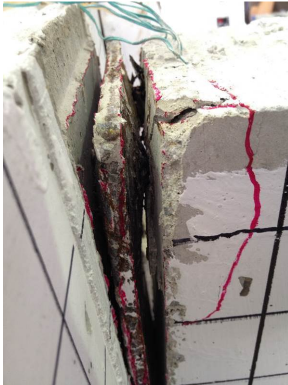
รูปที่ 2.21 การครากของเหล็กเสริมรับแรงดึงจากตัวอย่าง B19-6
