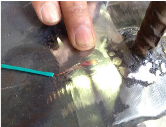
ติด Strain gauge พร้อมทั้งใส่ฟองอากาศ
