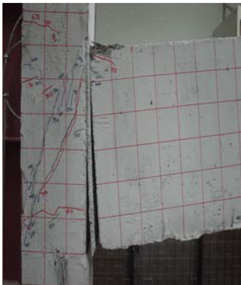
ลักษณะการแตกร้าวของคอนกรีตของตัวอย่างทดสอบ BC-4 [2]
