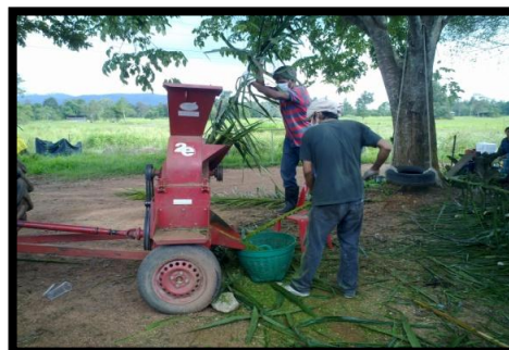
ภาพที่ 2 การสับทางใบปาล์มน้ำมันด้วย เครื่องย่อยพืชสด
