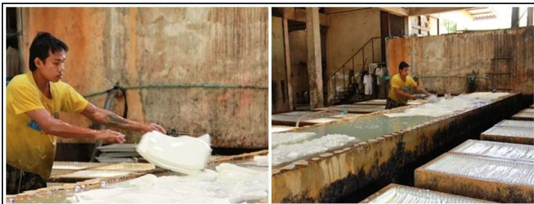
ภาพประกอบที่ 3-9 การลำเลียงยางแผ่นดิบก่อนรีด
