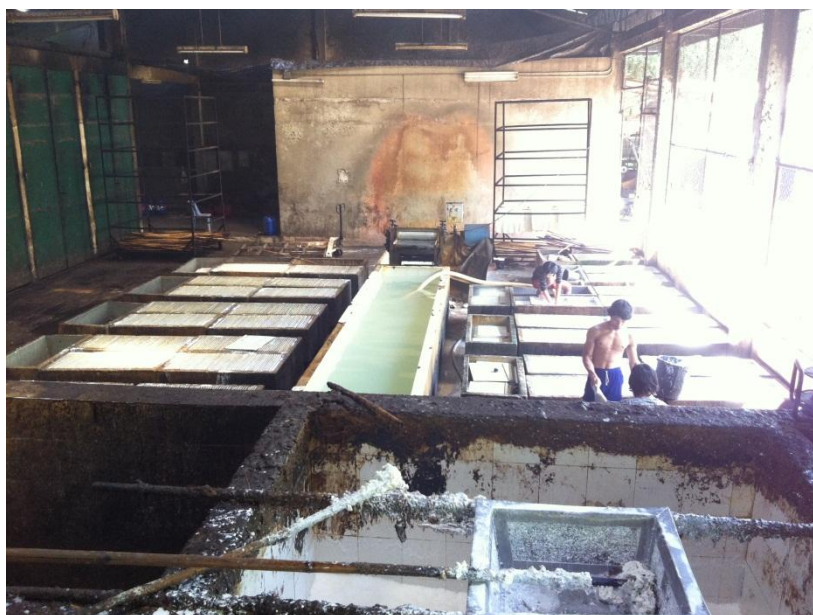
ภาพที่ ค-3 จุดน้ำยางจากบ่อพักลำเลียงไปยังบ่อจับเป็นยางแผ่น
