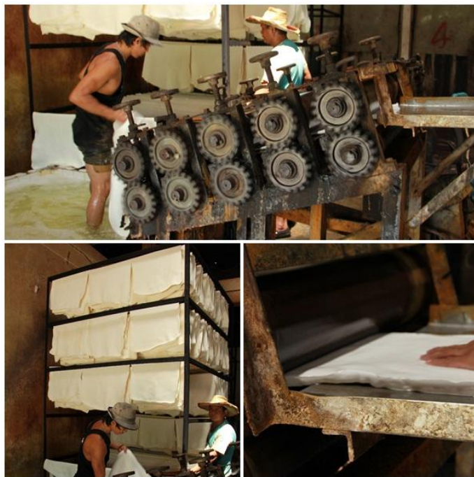
ภาพประกอบที่ 1-7 อุปกรณ์รีดยางแผ่นดิบ และการตากยางแผ่นดิบ
