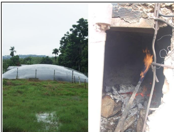
ภาพประกอบที่ 3-19 ก๊าซชีวภาพจากน้ำเสีย จะถูกนำมาใช้เป็นเชื้อเพลิงร่วมในการรมควันยาง
