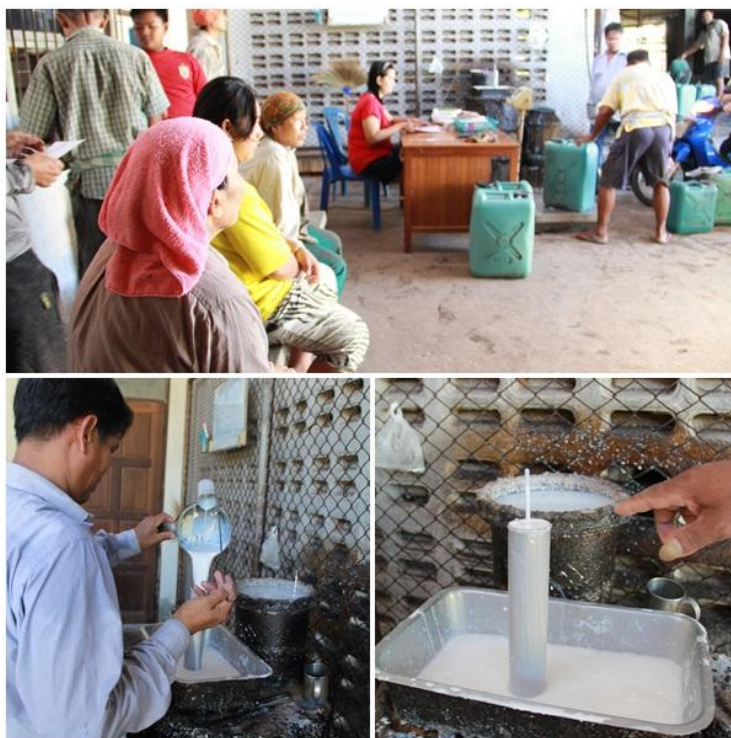
ภาพประกอบที่ 1-6 ขั้นตอนการรับน้ำยางสดและการคำนวณเปอร์เซ็นต์ DRG น้ำยางสด
