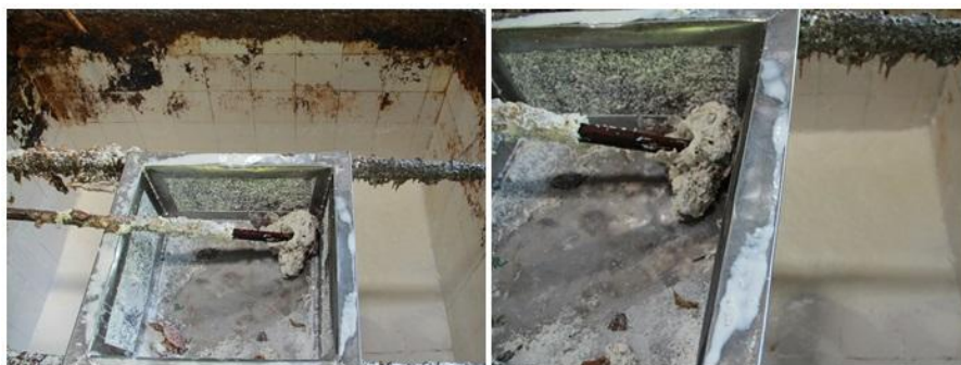
ภาพ ข. การกรองน้ำยางสดโดยใช้ตะแกรง เข้าสู่บ่อรับน้ำยางสด
