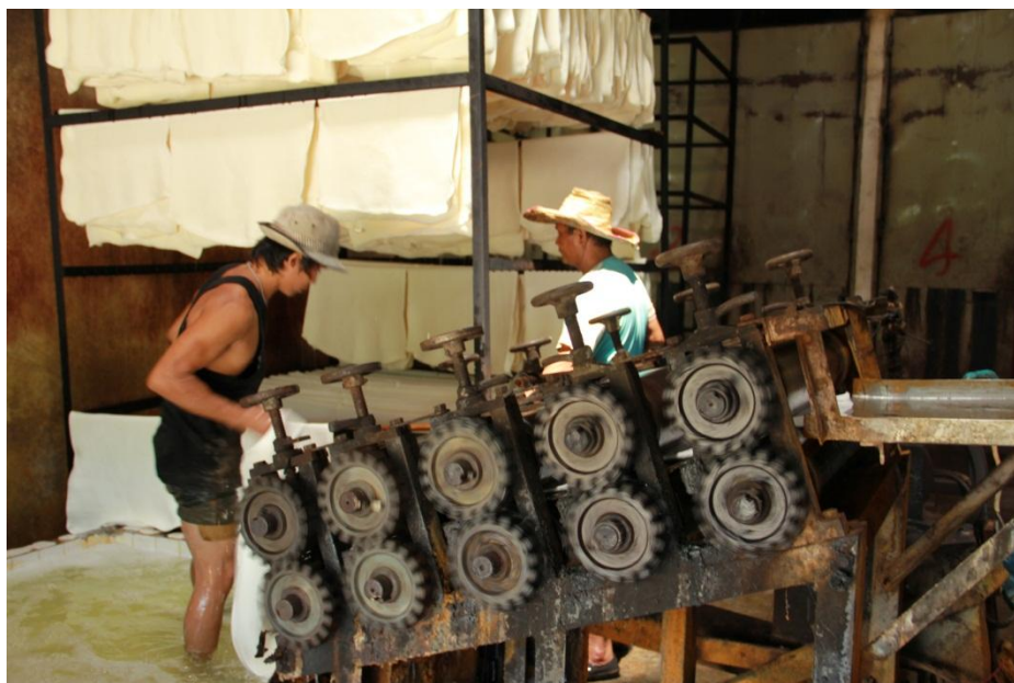
ภาพที่ ค-4 จุดนำน้ำยางแผ่นดิบมาผ่านเครื่องรีด
