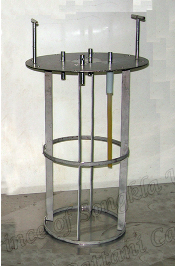
รูปที่ 4.6 (b) Baffle ที่สร้างติดพร้อมฝาถัง
