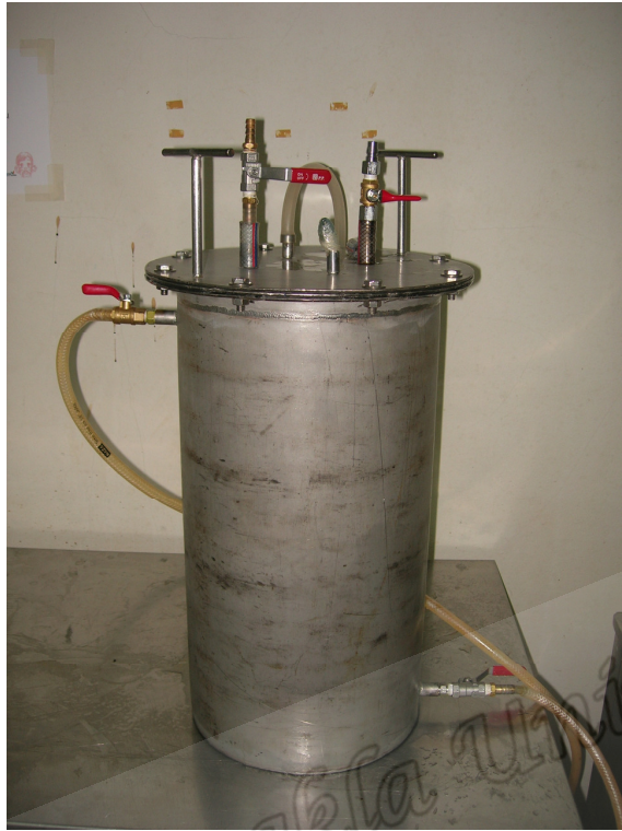
รูปภาคผนวก ง. ที่ 5 วาล์วและชุดควบคุมถังหมัก
