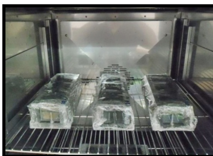
รูปที่ 3.23 นำตัวอย่างอบที่อุณหภูมิ 70^{\circ}\text{C} เป็นเวลา 24 ชั่วโมง
