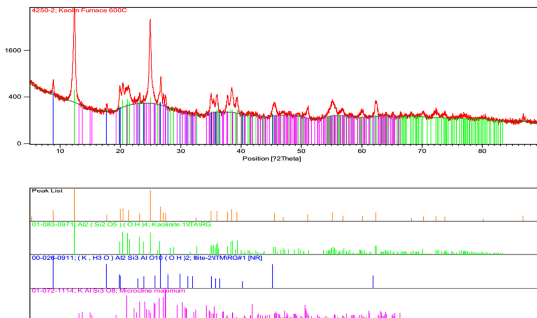
รูปที่ ข.2 ผลการวิเคราะห์ความเป็นผลึกของดินขาวเผาที่ 600°C เป็นเวลา 6 ชั่วโมง
