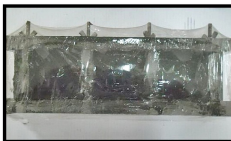
รูปที่ 3.22 หุ้มแบบหล่อโดยใช้แผ่นพลาสติกห่ออาหาร และตั้งตัวอย่างไว้ที่อุณหภูมิห้องเป็นเวลา 1 ชั่วโมงก่อนนำเข้าตู้อบ
