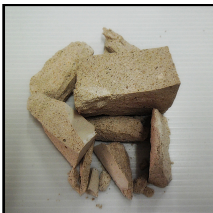
รูปที่ 4.8 แสดงการวิบัติของอีโพอลิเมอร์เพสต์ ซึ่งสังเคราะห์โดยใช้ดินขาวเผาที่ 750^{\circ}\text{C} โดยวิบัติในลักษณะแตกกระจาย
