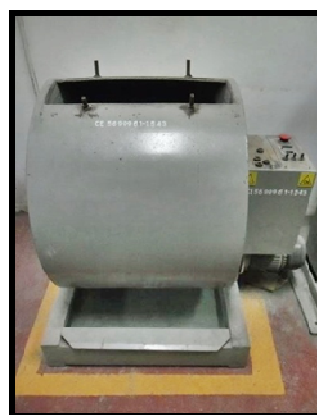
รูปที่ 3.4 อบวัสดุตั้งต้นก่อนนำไปทำการบด รูปที่ 3.5 เครื่องบดชนิดดี (Abrasion Machine)
