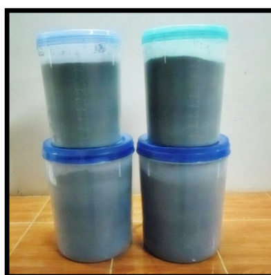
รูปที่ 3.6 เก็บวัสดุตั้งต้นที่เตรียมเสร็จแล้วไว้ในภาชนะที่กันความชื้นได้
