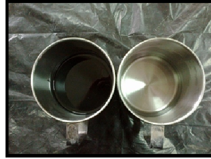
รูปที่ 3.17 เตรียมสารละลาย \text{Na}_2\text{SiO}_3 และ \text{NaOH} ตามที่กำหนดของแต่ละสูตรผสม
