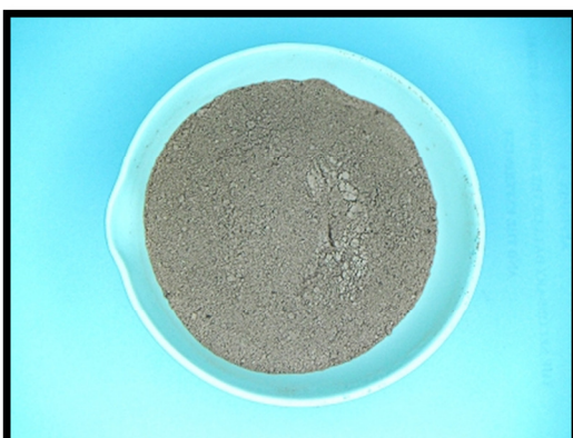
รูปที่ 3.3 กากอลูมิน่าที่ผ่านการบดละเอียด
