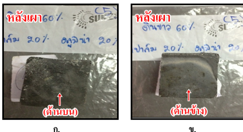
รูปที่ 4.52 จีโอโพลิเมอร์สูตร 60MK20PA20AW-15M(2.5) หลังทำการเผา ก.ด้านบน ข.ด้านล่าง
