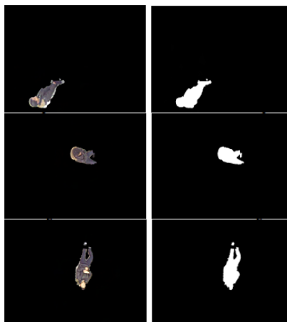
ภาพประกอบ 1-3 ผลลัพธ์จากเทคนิค background subtraction
