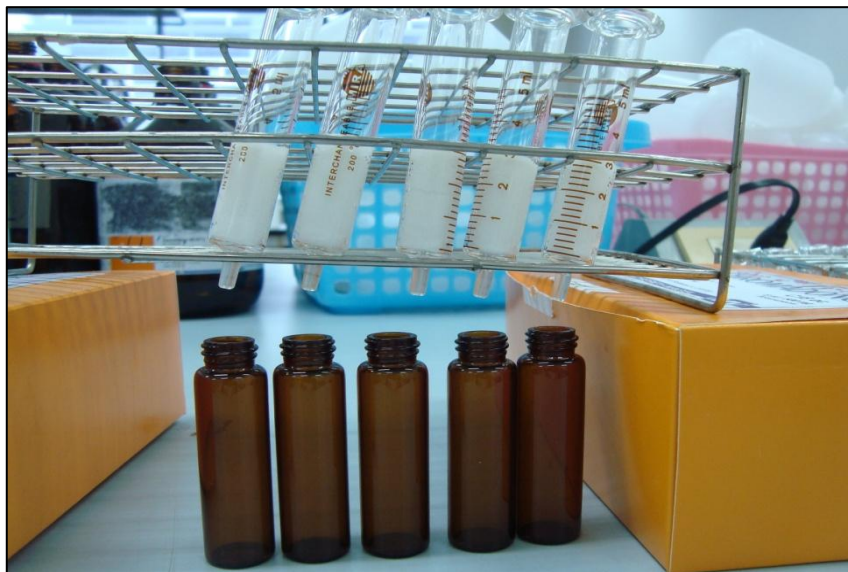
ภาพผนวก ก-5 ขั้นตอนการสกัดแบบใช้เทคนิคสกัดด้วยตัวดูดซับ (solid phase extraction, SPE)
