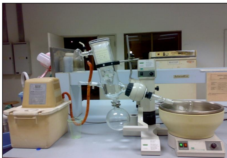
ภาพผนวก ก-4 การนำสารละลายตัวอย่างไประเหยเพื่อลดปริมาตรโดยอาศัยเครื่อง กลั่นระเหยแบบหมุน (rotary evaporator)
