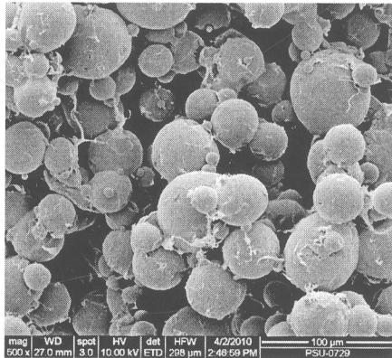
รูปที่ 20 ผงละเอียดสีขาวของพอลิคาโพรแลคโตนไมโครสเฟียร์ที่เตรียมจากการใช้ 0.5% PVA เป็นตัวประสาน (A) ภาพจากกล้องจุลทรรศน์อิเล็กตรอนแบบส่องกราด แสดงลักษณะทรงกลมของพอลิคาโพรแลคโตนไมโครสเฟียร์ที่กำลังขยาย 150 เท่า (B) และที่กำลังขยาย 500 เท่า (C)
