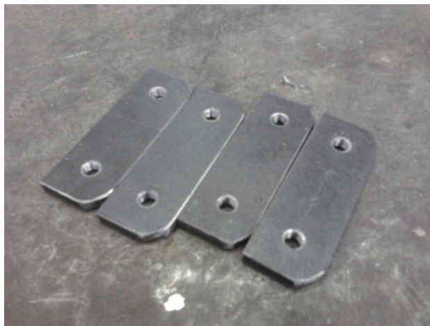
รูปที่ 3.32 ขายึดเพลารองรับน้ำหนักส่วนบน
