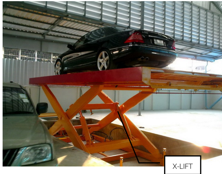
รูปที่ 2.3 เอ็กส์ลิฟท์ที่ใช้ยกรถในอู่ซ่อมรถยนต์
