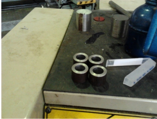
รูปที่ 3.33 สร้างบูชชายัดเพลารองรับน้ำหนักส่วนบน
