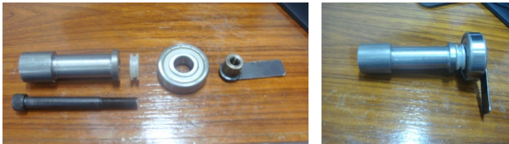
รูปที่ 3.25 ประกอบลูกปืนเข้ากับปั๊มชนิดแขนยก
