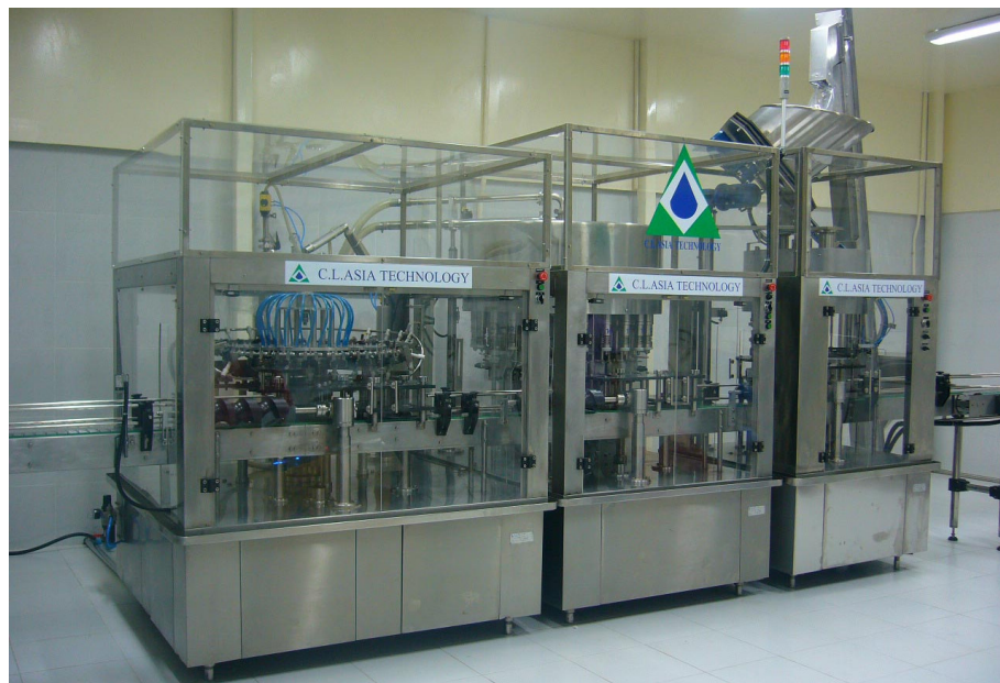
รูปที่ 2.4 ตัวอย่างเครื่องที่ใช้ระบบนิวแมติกส์เครื่อง PACKING 3 ระบบการล้าง บรรจุและปิดฝาขวดโดยใช้ระบบนิวแมติกส์ร่วมในการทำงาน(ที่มา: http://www.cl-techno.com )
