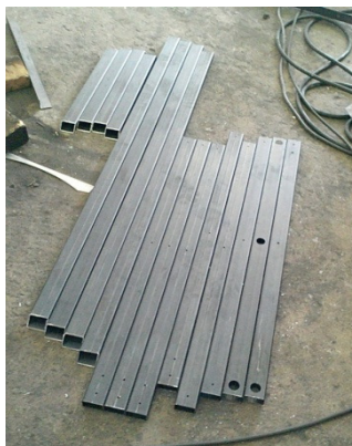
รูปที่ 3.13 แสดงชิ้นส่วนของโครงสร้างที่ผ่านการตัดเรียบร้อยแล้ว
