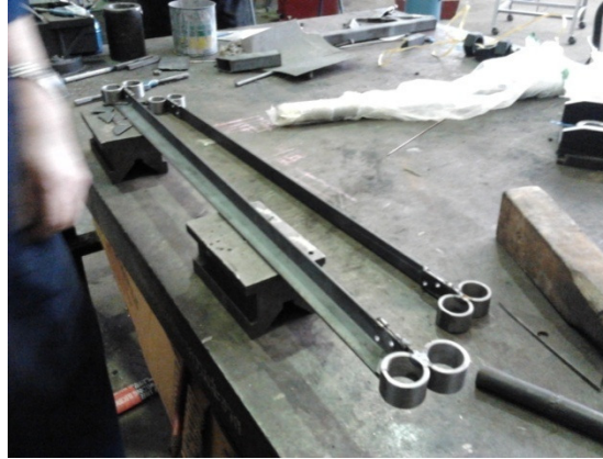
รูปที่ 3.36 นำล้อลูกปืนสไลด์ที่กลึงเสร็จมาเชื่อมประกอบแขนประคองลูกปืนสไลด์
