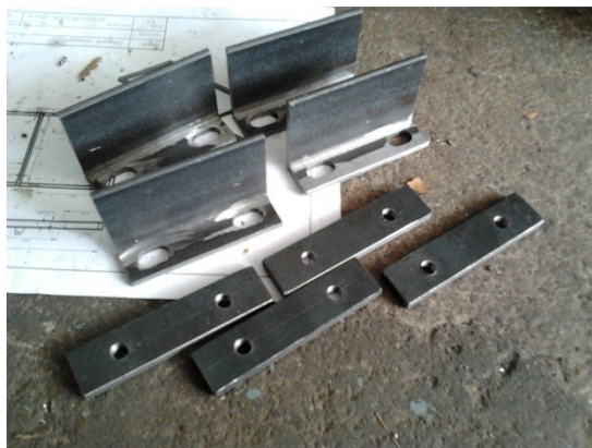
รูปที่ 3.29 สร้างขายึดเพลารองรับน้ำหนักแผ่นสไลด์
