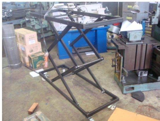
รูปที่ 3.26 นำชิ้นส่วนโครงสร้างทั้งหมดประกอบเข้าด้วยกัน
