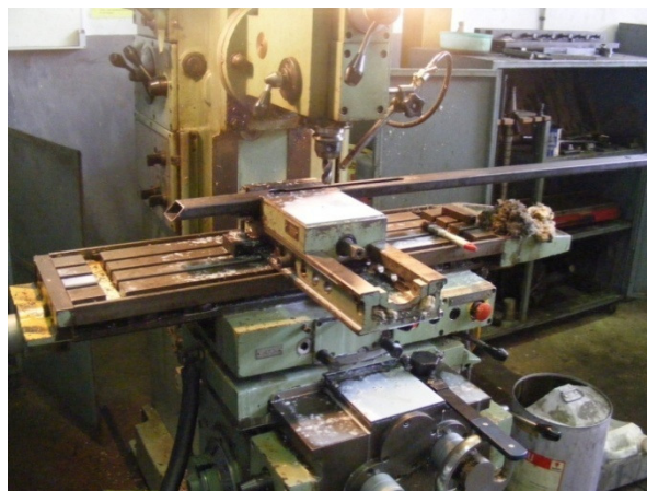
รูปที่ 3.16 ใช้เครื่องกัดเซาะร่องกรอบบน และล่าง
