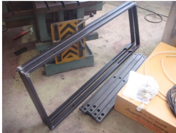
รูปที่ 3.18 นำชิ้นส่วนของกรอบบนและล่างมาเชื่อมประกบกันโดยเครื่องเชื่อมไฟฟ้า
