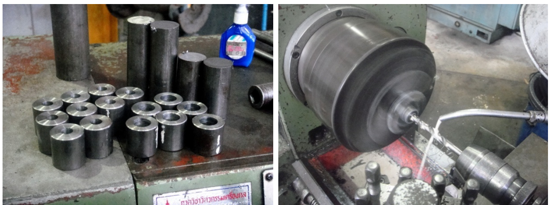
รูปที่ 3.19 สร้างบูชียึดโครงสร้างโดยใช้เครื่องกลึง
