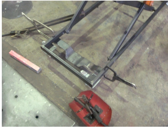
รูปที่ 3.27 หาดำแหน่งขายึดปั้มไฮดรอลิกและเชื่อมประกอบ
