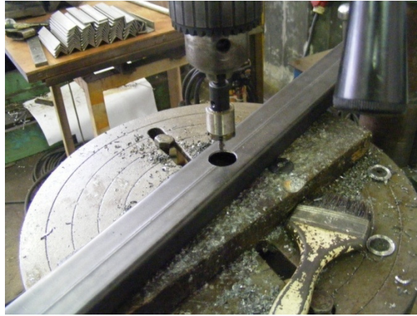
รูปที่ 3.14 เจาะรูแขนเอ็กส์ลิฟท์ตามตำแหน่งโดยใช้ดอกโฮลด์ซอร์ว
