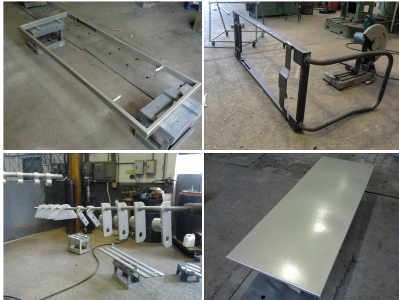
รูปที่ 3.43 ล้างทำความสะอาดชิ้นส่วน พ่นสีรองพื้นและพ่นสีจริง
