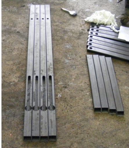
รูปที่ 3.17 ชิ้นงานที่ผ่านการเจาะร่อง
