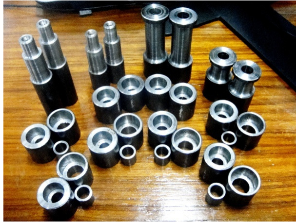
รูปที่ 3.20 บูชียัดโครงสร้างที่ผ่านการกลึงตามแบบเพื่อเชื่อมกับแขนยก
