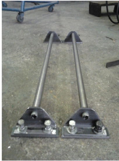
รูปที่ 3.31 ลมมูมขายึดเพลารองรับน้ำหนักแผ่นสไลด์และประกอบกับเพลลา
