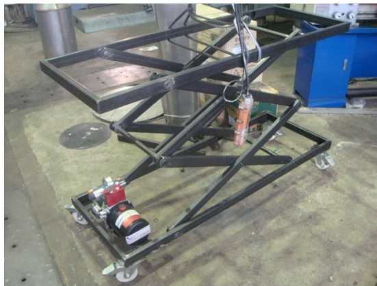
รูปที่ 3.28 ตำแหน่งการติดตั้งปั้มไฮดรอลิก
