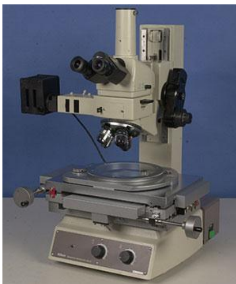
รูปที่ 14 กล้องจุลทรรศน์ชนิดวัดระยะ (10X)
