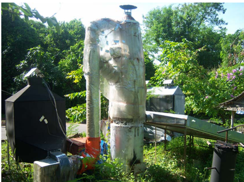
รูปที่ 4.19 ภาพถ่ายของเครื่องอบกล้วยเล็บมือนางด้วยพลังงานแสงอาทิตย์ร่วมกับพลังงานชีวมวล
