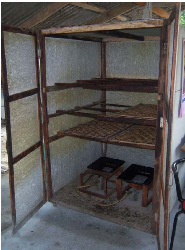
รูปที่ 3.3 เครื่องอบแห้งพลังงานจากแก๊สหุงต้มของวิสาหกิจชุมชนกลุ่มแม่บ้านเกษตรกรสวนจันทร์ศรี
