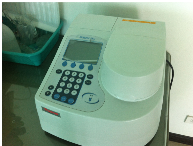
รูปที่ 2.6 เครื่อง UV-Vis Spectrometer Thermo Scientific Genesys 10UV
