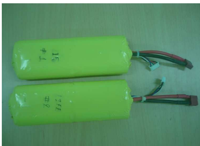
ภาพประกอบ 3-30 แบตเตอรี่ลิเทียมฟอสเฟต (Li-Fe)
