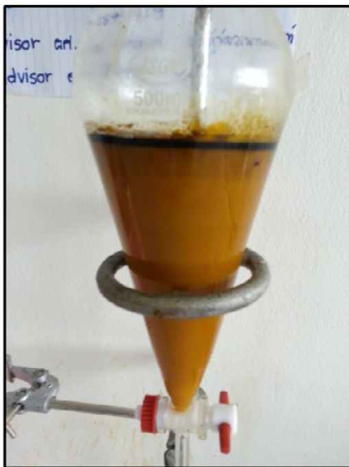
ภาพประกอบที่ 4-17 ลักษณะการแยกชั้นของไบโอดีเซลที่ได้จากน้ำมันสาหร่ายชั้นบน ในขั้นตอนการล้างด้วยน้ำอุ่น
