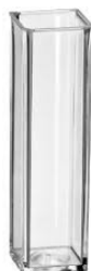
ภาพประกอบที่ ข-2 อุปกรณ์ใส่ตัวอย่างที่ต้องการวิเคราะห์ ด้วยเครื่อง UV- Spectrophotometer
