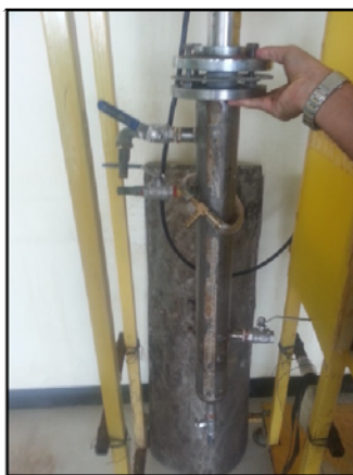
ภาพประกอบที่ 3-7 การติดตั้งถังปฏิกรณ์เข้ากับฮอว์น
