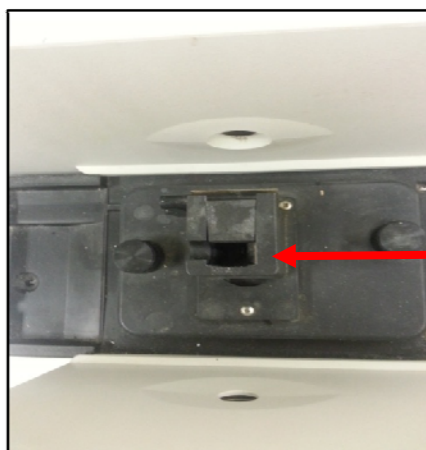
ภาพประกอบที่ ข-4 ช่องใส่เซลล์ (Cuvette) ของเครื่อง UV- Spectrophotometer
