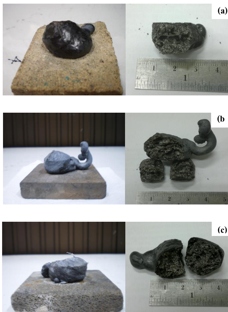
รูปที่ 3.5 ชิ้นงานที่ผ่านการจุดระเบิดในกระบวนการ SHS ที่อัตราส่วนเชิงโมลของ Al ในสารตั้งต้นต่างกัน (a) 4 โมล (b) 4.33 โมล และ (c) 5 โมล
