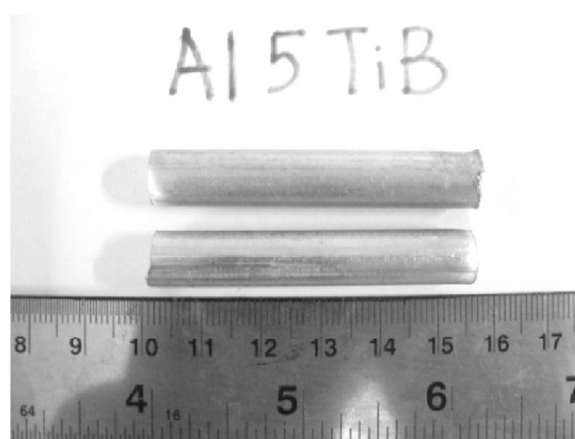
รูปที่ 3.1 ลักษณะแท่ง Al5Ti1B ที่ใช้ในงานวิจัย
