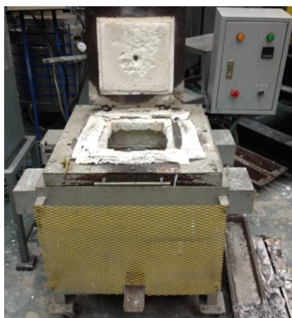
รูปที่ 3.2 เตาหลอมไฟฟ้าชนิดขดลวดต้านทานที่ใช้ในงานวิจัย
