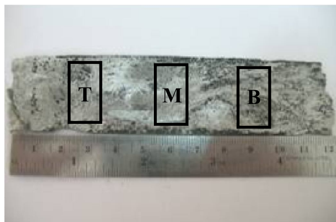
รูปที่ 3.9 ตัวอย่างชิ้นงานจากแม่พิมพ์ทองแดงและบริเวณที่ทำการวิเคราะห์โครงสร้างจุลภาค
