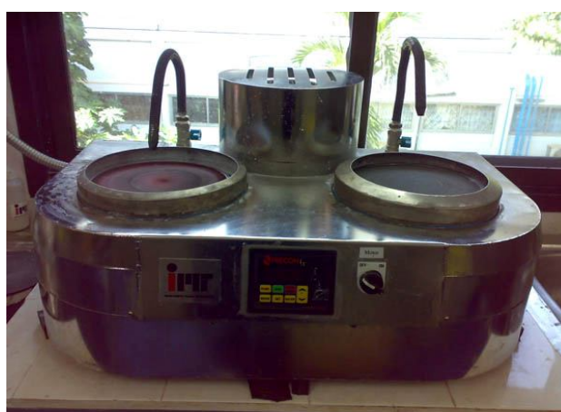
รูปที่ 3.13 เครื่องขัดชิ้นงานที่ใช้ในงานวิจัย
