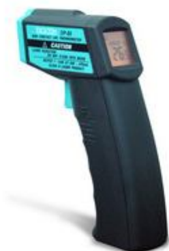
รูปที่ 3.6 เทอร์โมคัปเปิลแบบอินฟราเรด (DP88) ที่ใช้งานวิจัย
