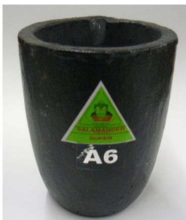
รูปที่ 3.3 เบ้ากราไฟต์ที่ใช้ในงานวิจัย
