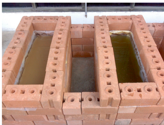
ภาพประกอบที่ 3.6 ตัวอย่างระบบบึงประดิษฐ์ในระดับห้องปฏิบัติการ
