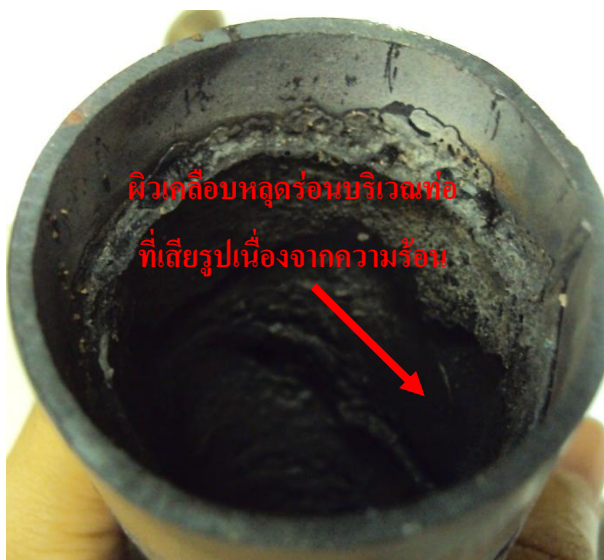
รูปที่ 3.22 ภาพแสดงบริเวณชั้นผิวเคลือบผลิตภัณฑ์บริเวณที่ท่อเสียรูปทรง
