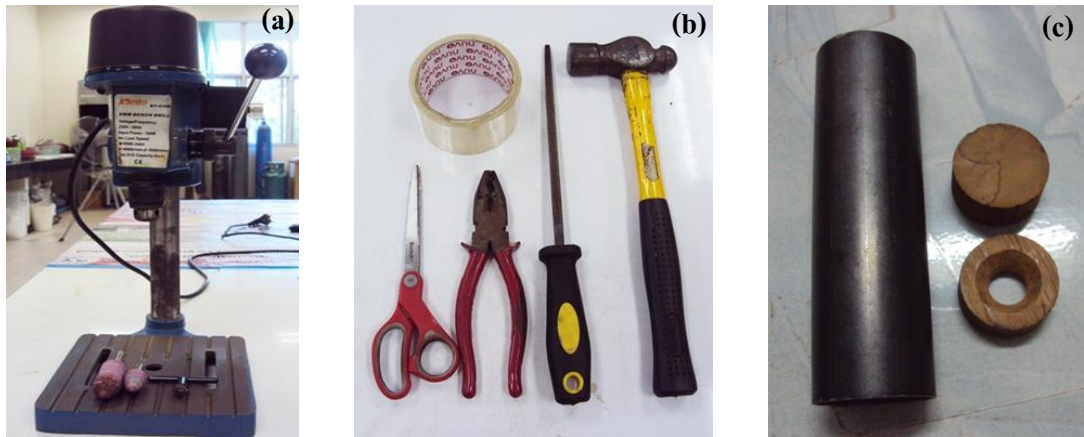
รูปที่ 2.2 วัสดุ และเครื่องมือที่ใช้เตรียมชิ้นงานสังเคราะห์ (a) เครื่องเจาะมอเตอร์ไฟฟ้าขนาดเล็ก (b) ค้อน ตะไบ คริม กรรไกร เทปกาว และ (c) ท่อโลหะ จุกไม้
