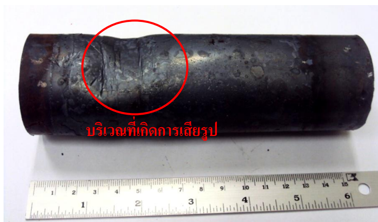
รูปที่ 3.21 ลักษณะท่อโลหะหลังการสังเคราะห์ที่เสียรูปทรง
