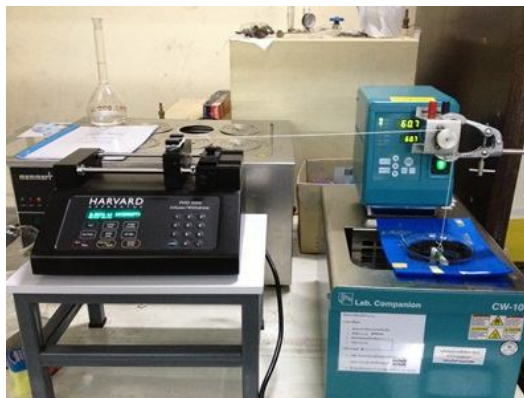
ภาพประกอบที่ 3.9 การจัดวางตำแหน่งของอ่างควบคุมความร้อนและเครื่องควบคุมการเคลื่อนที่ของแผ่นฟิล์มในระหว่างการกัดขยายรอยแฝง
