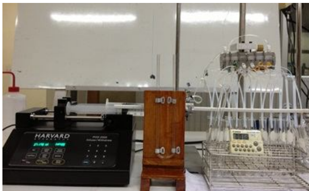
ภาพประกอบที่ 3.19 แสดงภาพชุดระบบทดสอบอัตราการไหลของน้ำผ่านเมมเบรน
