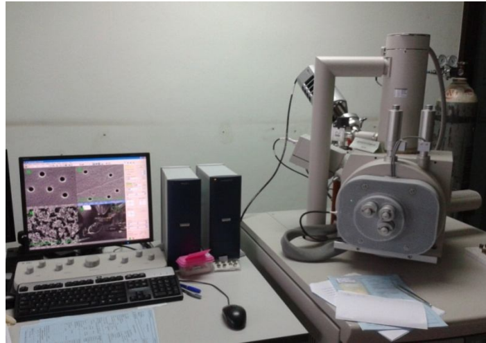
ภาพประกอบที่ 3.13 การถ่ายภาพพอร์นบนแผ่นเมมเบรนด้วยกล้องจุลทรรศน์อิเล็กตรอนแบบส่องกราด (SEM) ( FEI รุ่น Quanta 400) ของศูนย์เครื่องมือวิทยาศาสตร์ มหาวิทยาลัยสงขลานครินทร์
