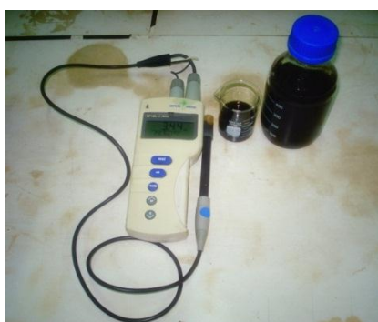
ภาพที่ 12 เครื่องวัดความเป็นกรดต่างชนิดแท่งแก้วอิเล็กโทรด (ภาพโดย อติสร เศรษฐพงศ์ พ.ศ. 2554)
