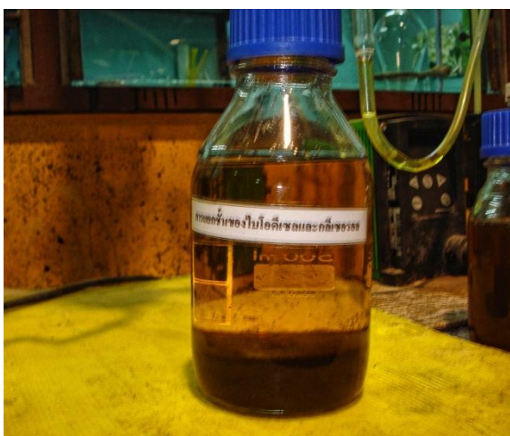
ภาพที่ 4 การแยกชั้นของกลีเซอรินดิบจากไบโอดีเซลหลังจากวางทิ้งไว้ประมาณ 5-10 นาที
