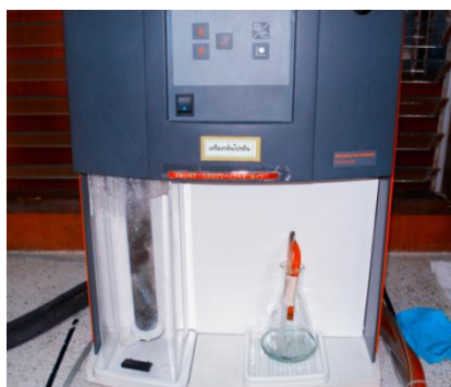
ภาพที่ 14 เครื่องกลั่นโปรตีนสำหรับการวิเคราะห์โปรตีนรวม
