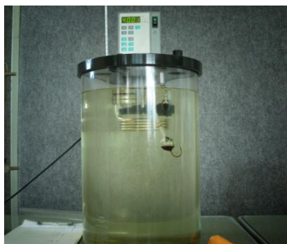
ภาพที่ 11 เครื่องวิเคราะห์ความหนืดจลน์แบบ glass capillary (ภาพโดย อติสร เศรษฐพงศ์ พ.ศ. 2554)
