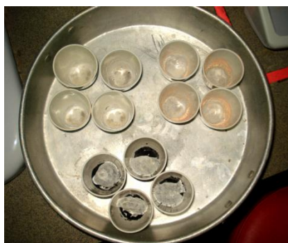
ภาพที่ 16 การวิเคราะห์เถ้ากลีเซอรินดิบตามวิธีของ AOAC (2005) (ภาพโดย อติสร เสรษฐพวงศ์ พ.ศ. 2554)
