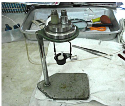
ภาพที่ 17 เม็ดสำลีที่หยดกลีเซอรินดิบก่อนนำไปวิเคราะห์หาค่าพลังงาน (ภาพโดย อติสร เสริมฐพงษ์ พ.ศ. 2554)
