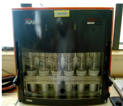
ภาพที่ 13 เครื่องสกัดซอกซ์เลต สำหรับสกัดไขมันจากกลีเซอรินดิบ
