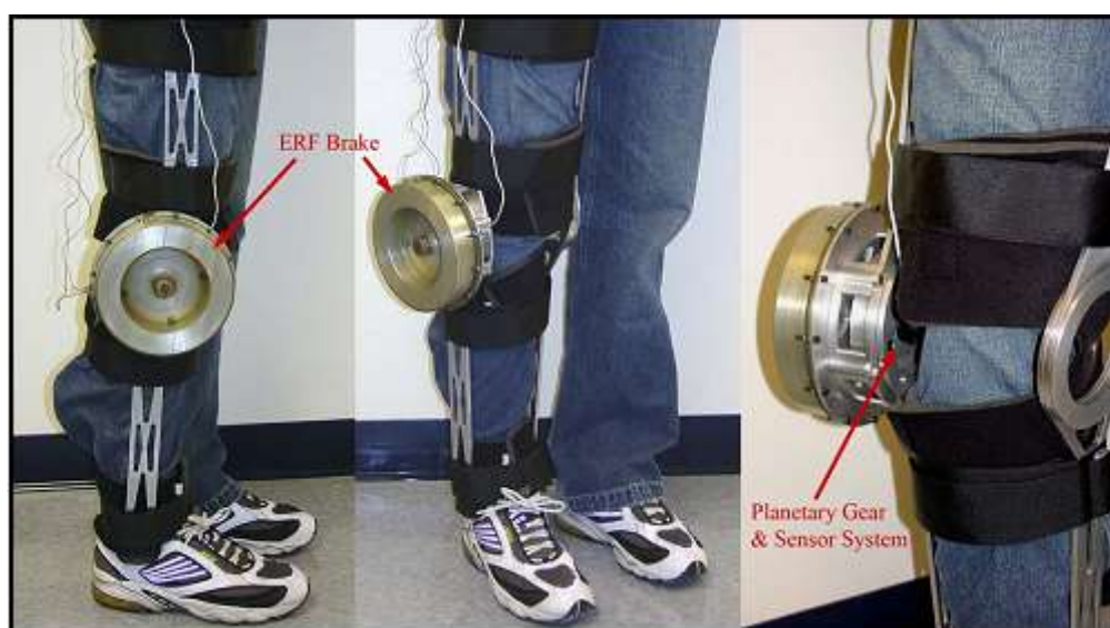
ภาพประกอบ 1 - 4 Electro-Rheological Fluid Based Knee Device [7]
