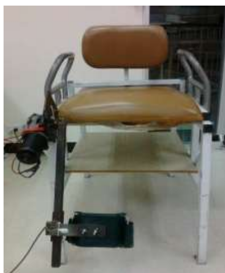
ภาพประกอบที่ 3 – 14 ชุดทดลองวัดแรงด้วยเซ็นตรนเกที่ประกอบด้วยกลไกออกแรงเตะ
