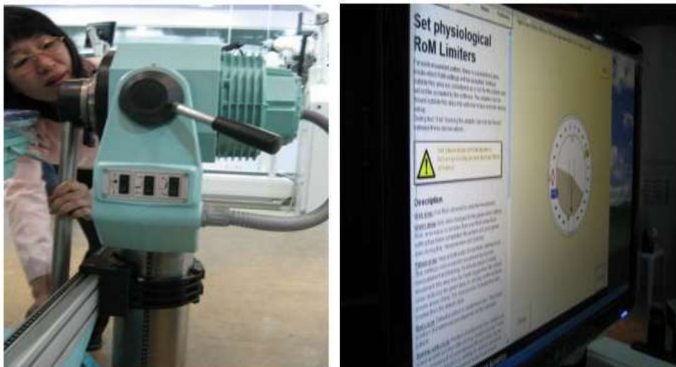
ภาพประกอบที่ 2 – 14 ตัว Dynamometer และการตั้งค่าความปลอดภัยด้วย ROM limiters
