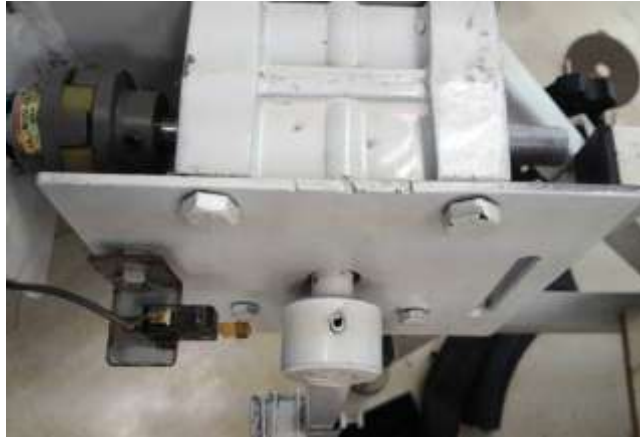
ภาพประกอบที่ 3 – 1 เป็นยัดจับมอเตอร์เข้ากับเกียร์
