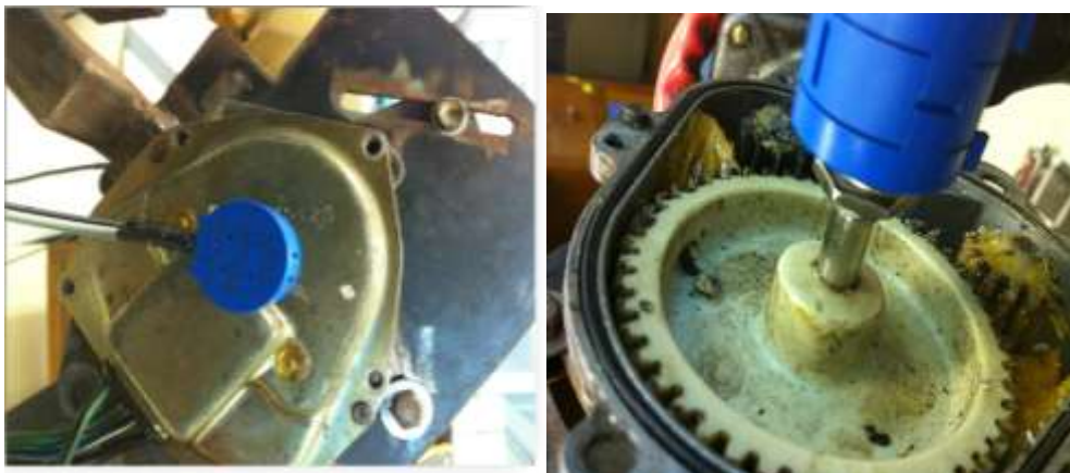
ภาพประกอบที่ 3 – 8 Potentiometer ใช้วัดมุมที่เปลี่ยนแปลงของข้อเข้า
