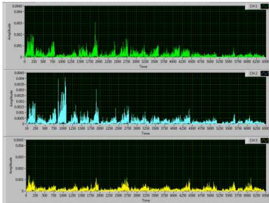
ภาพประกอบที่ 3 - 33 ตัวอย่างสัญญาณไฟฟ้ากล้ามเนื้อที่ได้จากการวิเคราะห์ค่า MAV
