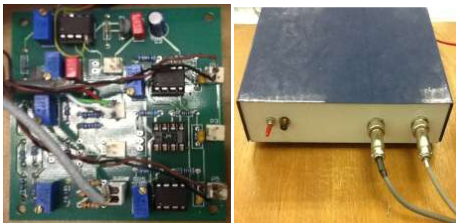
ภาพประกอบที่ 3 – 20 วงจรขยายสัญญาณอุปกรณ์สเตรนเกจและโพเทนชิโอมิเตอร์
