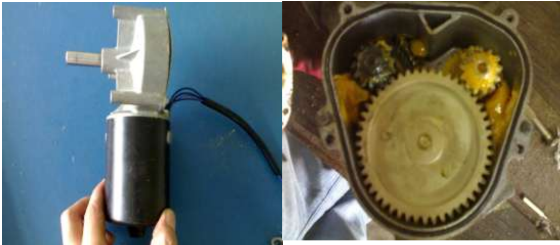
ภาพประกอบที่ 3 – 5 ภาพมอเตอร์ปั้ดน้ำฝนที่ใช้ในการออกแบบ
