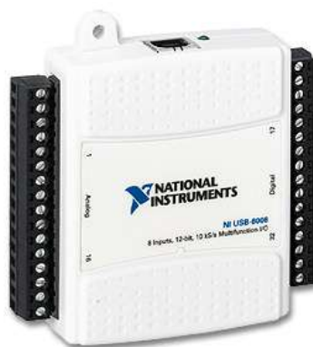
ภาพประกอบที่ 3 – 23 DAQ (Data acquisition card) รุ่น 6009 [30]
