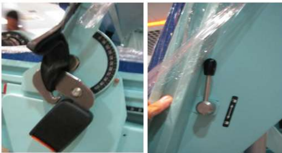
ภาพประกอบที่ 2 – 13 ส่วนปรับพนักพิงและตัวล็อกการเอียงของพนักพิง
