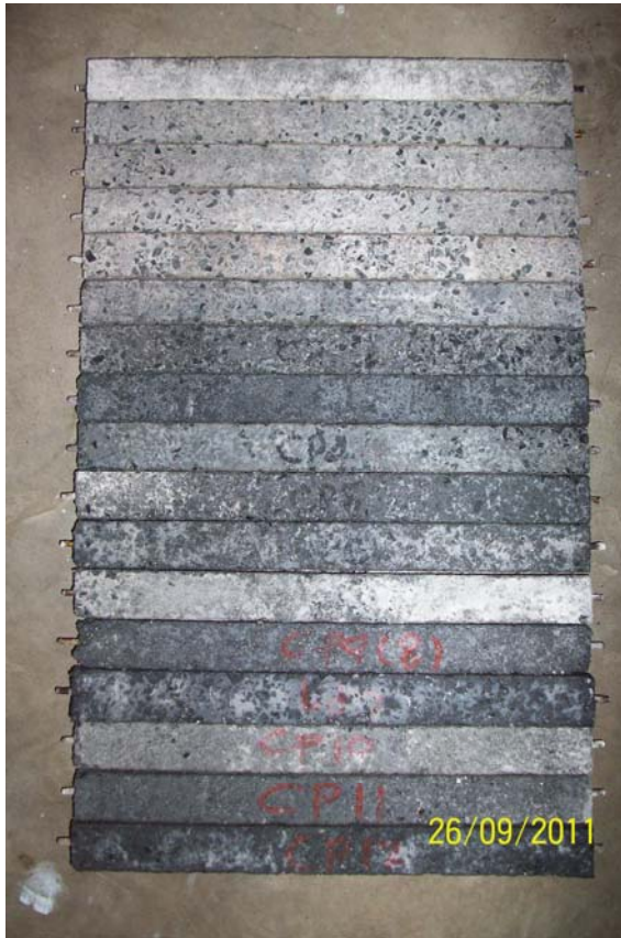
รูปที่ 9 รูปตัวอย่างของมอร์ต้าร์มวลรวมเศษกระจกที่ใช้ในการทดสอบการต้านทานปฏิกิริยาอัลคาไลซิลิกา
