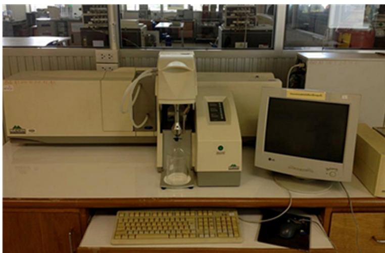
ภาพประกอบที่ ก-5 เครื่อง Particle size analyzer Malvern รุ่น Mastersizer 2000 ที่ใช้ในการวิเคราะห์การกระจายขนาดของผงพอลิเอทิลีนแวกซ์
