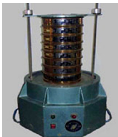
ภาพประกอบที่ ก-4 ชุดตะแกรงร่อนพร้อมเครื่องสั่นที่ใช้คัดแยกขนาดผงพอลิเอทิลีนแวกซ์
