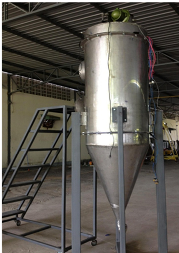
ภาพประกอบที่ 4-9 ห้องฟ่นละอองที่สร้างเพื่อใช้ในการทดลอง
