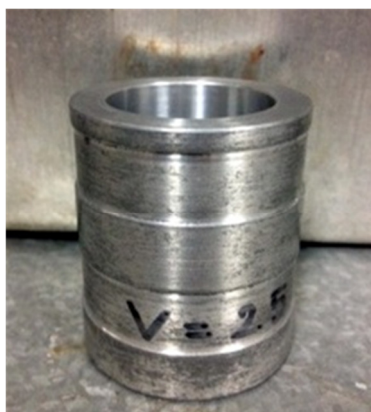
ภาพประกอบที่ ก-10 กระบอกดวงสแตนเลสที่ใช้หาค่า Bulk density ของผงพอลิเอทิลีนแวกซ์
