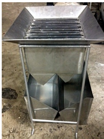
ภาพประกอบที่ ก-1 ลักษณะ Riffle splitter ที่ใช้ในการทดลอง
