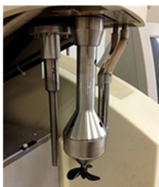
ภาพประกอบที่ ก-7 แท่นกวนและใบพัดกวนของระบบป้อนสาร
