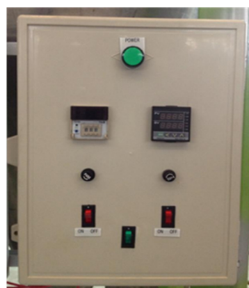
(ข) ชุดควบคุมอุณหภูมิของหัวฉีด
