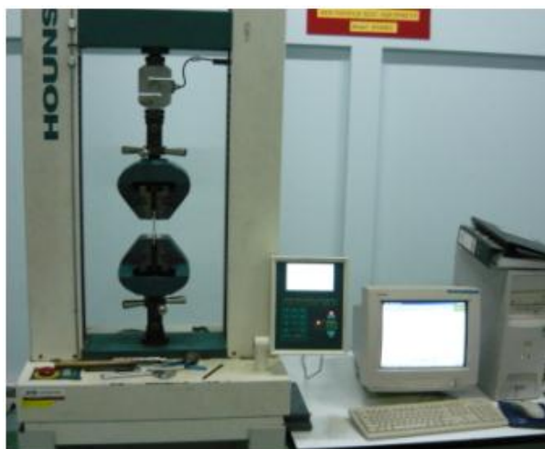
รูปที่ 3.10 แสดงการทดสอบแรงดึงด้วยเครื่องทดสอบ
