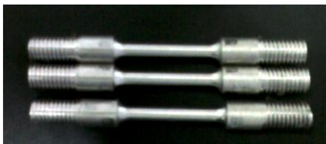
รูปที่ 3.9 แสดงภาพชิ้นงานทดสอบแรงดึงตามมาตรฐาน ASTM-B 557M
