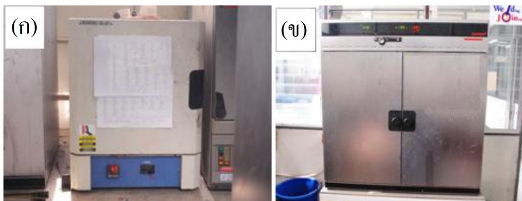
รูปที่ 3.6 (ก) แสดงภาพเตาเผาอุณหภูมิต่ำสำหรับการอบละลาย
