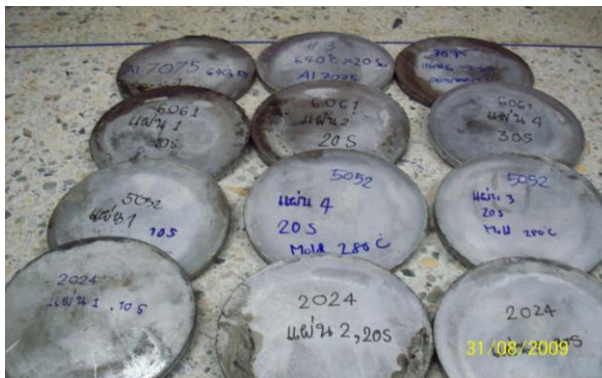
รูปที่ 2.13 แสดงแผ่นโลหะผสมอะลูมิเนียมเกรดต่าง ๆ ที่ได้จากการหล่ออัดขึ้นรูป
