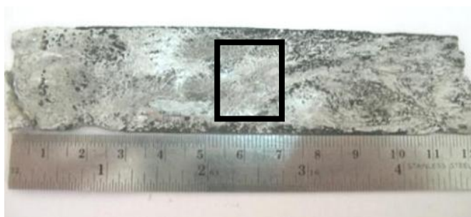
รูปที่ 3.26 แสดงชิ้นงานจากแม่พิมพ์ทองแดง และบริเวณตรงกลางที่นำไปวิเคราะห์หาสัดส่วนของของแข็ง
