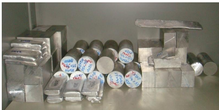
รูปที่ 2.9 แสดงแท่งอะลูมิเนียมผสมในกลุ่มรีด (Wrought Aluminum Alloy) ที่ใช้สำหรับศึกษาผลเบื้องต้นการแปรรูปโลหะกึ่งของแข็งของอะลูมิเนียมผสมในกลุ่มรีดด้วยการพ่นฟองแก๊สขณะแข็งตัว
