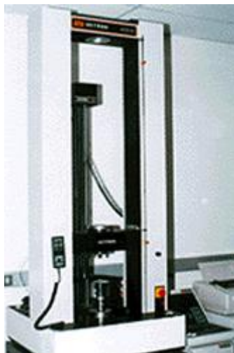
รูปที่ 2.37 แสดงเครื่อง Instron Universal Model 4502 ที่ใช้ในการทดสอบแรงดึงและการดัดงอ ชิ้นงานวัสดุผสมเนื้ออะลูมิเนียมเกรด 7075 ที่เสริมแรงด้วยซิติคอนคาร์ไบด์เนื้อพรุน
