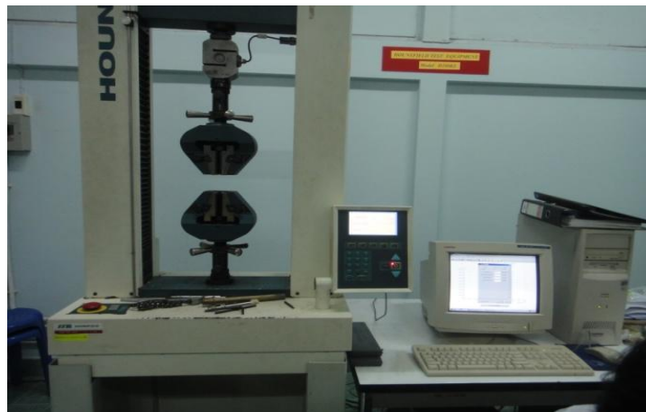
รูปที่ 2.16 แสดงเครื่องทดสอบความสามารถในการต้านทานแรงดึง Universal Testing Machine
