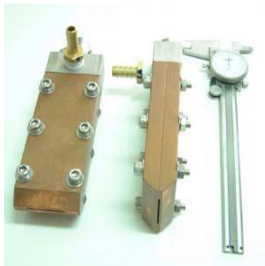
รูปที่ 2.22 แสดงแม่พิมพ์ทองแดง (Copper Quenching Mold) เพื่อเก็บตัวอย่างของน้ำโลหะอะลูมิเนียมกึ่งของแข็ง
