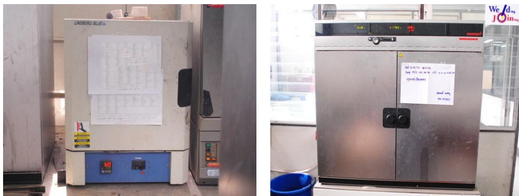
รูปที่ 2.14 แสดงภาพเตาสำหรับการให้ความร้อนชิ้นงาน เตาสำหรับอบละลาย (Solution Heat Treatment) (ซ้าย) และ เตาสำหรับบ่มเทียม (Artificial aging) (ขวา)
