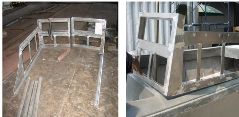
รูปที่ 2.43 แสดงโครงยึดกระดาษที่ทางกรมอุทกหารเรือจัดสร้างเพื่อประกอบกับแผ่นกระดาษกันกระสุน (ซ้าย) โครงยึดกระดาษเมื่อประกอบเข้ากับเรือโจมถ้ำน้ำต้นแบบ (ขวา)
