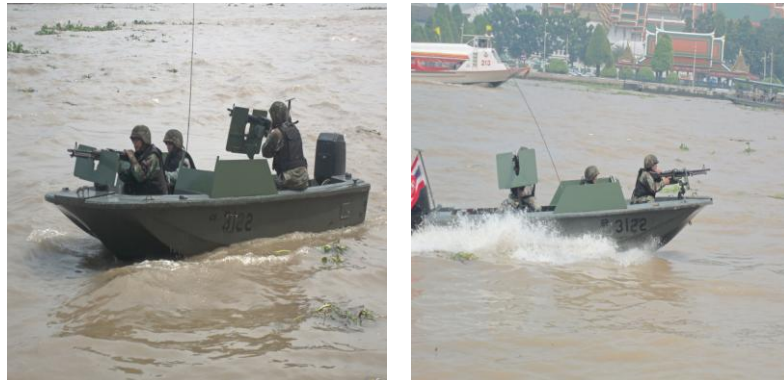
รูปที่ 3.49 แสดงการทดสอบในน้ำของเรือจู่โจมลำน้ำ กองเรือลำน้ำ หลังจากประกอบแผ่นเกราะเข้ากับตัวเรือต้นแบบ
