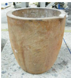
รูปที่ 2.2 แสดงเบ้าหลอมโลหะชนิด Graphite-clay base ที่ใช้ในงานวิจัยนี้
