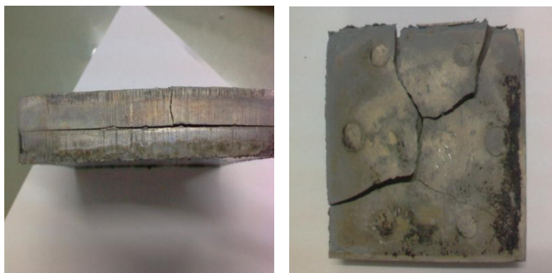
รูปที่ 3.37 แสดงรูปชิ้นงานเกราะกันกระสุนที่เกิดรอยแตกร้าวหลังจากการขึ้นรูป
