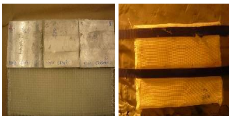
รูปที่ 2.39 แสดงแผ่นเกราะกันกระสุนที่เตรียมสำหรับทดสอบความสามารถในการต้านทานการทำลายของกระสุนขนาด 7.26 มิลลิเมตร (ซ้าย) แผ่นเกราะกันกระสุนที่หุ้มเคฟลาร์ (Kevlar) และประกอบเข้ากับกระเบดินตามมาตรฐาน NIJ สำหรับการยิงทดสอบแผ่นเกราะกันกระสุน (ขวา)
