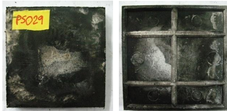
รูปที่ 3.38 แสดงรูปชิ้นงานเกราะกันกระสุนหลังจากได้รับการปรับปรุงแม่พิมพ์
