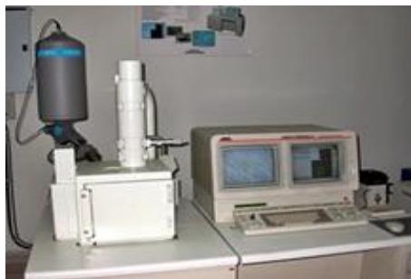
รูปที่ 2.21 แสดงกล้องจุลทรรศน์อิเล็กตรอนแบบส่องกราด ยี่ห้อ JEOL รุ่น JSM 5800
