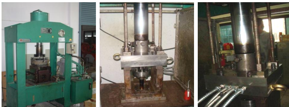
รูปที่ 2.4 แสดงเครื่องอัดไฮดรอลิกขนาด 80 ตัน (ซ้าย) ชุดดันปลดชิ้นงาน (กลาง) ชุดให้ความร้อนแก่แม่พิมพ์ (ขวา)
