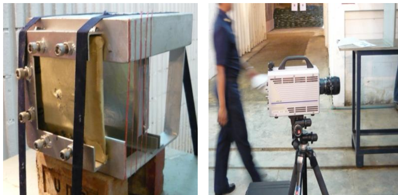
รูปที่ 2.41 แสดงการติดตั้งแผ่นเกราะกันกระสุนสำหรับการศึกษาถึงพฤติกรรมการพังทลายของเกราะกันกระสุนเมื่อได้รับแรงประทะจากกระสุนปืน (ซ้าย) กล้องความเร็วสูงที่ใช้จับภาพพฤติกรรมการพังทลายของแผ่นเกราะกันกระสุนในงานวิจัยนี้ (ขวา)
