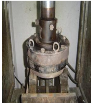
รูปที่ 2.5 แสดงแม่พิมพ์สำหรับงานหล่ออัด (Squeeze Casting) ที่มีขนาดเส้นผ่านศูนย์กลาง 20 เซนติเมตร ที่ติดตั้งบนเครื่องอัดไฮดรอลิก (ซ้าย) แสดงแบบของแม่พิมพ์ (ขวา)
