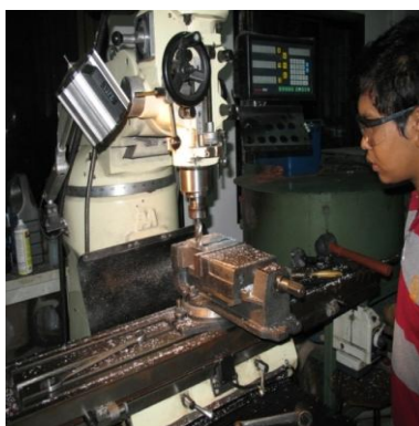
รูปที่ 2.38 แสดงกรรมวิธีการกัดผิวหน้าแผ่นเกราะกันกระสุน (Milling Surface) ในงานวิจัยนี้ได้ใช้เครื่องเครื่องกัดแนวตั้ง (Vertical Milling Machine)
