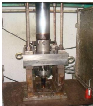
รูปที่ 2.6 แสดงแม่พิมพ์รูปทรงสี่เหลี่ยมขนาด 10x10 เซนติเมตร พร้อมชุดต้นปลัดชิ้นงานและชุดให้ ความร้อนที่ติดตั้งบนเครื่องอัดไฮดรอลิก (ซ้าย) แสดงแบบของแม่พิมพ์ (ขวา)
