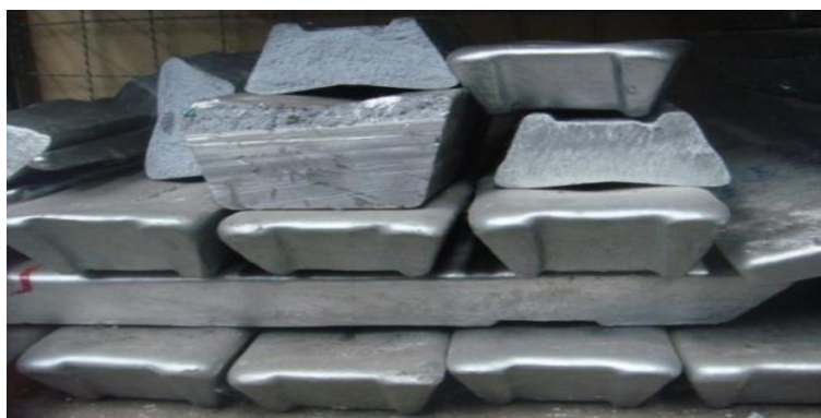
รูปที่ 2.25 แสดงแท่งอะลูมิเนียมผสมเกรด 7075 ชนิด Secondary alloy ที่ใช้สำหรับการผลิตแผ่นเกราะกันกระสุนสำหรับเรือต้นแบบของกองเรือลำน้ำทัพเรือไทย
