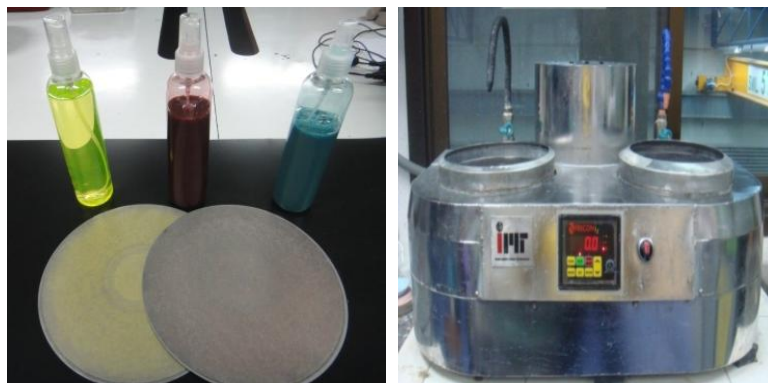
รูปที่ 2.35 แสดงอุปกรณ์ที่ใช้ในการขัดแผ่นเกราะเพื่อ โครงสร้างจุลภาค
