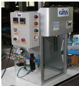
รูปที่ 2.3 แสดงเครื่องผลิตโลหะกึ่งของแข็งด้วยการพ่นฟองแก๊สขณะแข็งตัวที่มีชื่อว่า GISS
