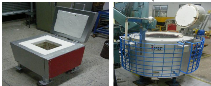
รูปที่ 2.1 แสดงเตาหลอมไฟฟ้าแบบลวดความต้านทานที่ใช้ในการทดลอง
