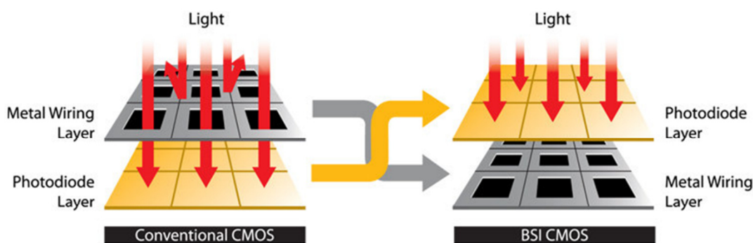
รูปที่ 4.17 โครงสร้างเซนเซอร์รับภาพชนิดซีมอส และชนิดบีเอสไอซีมอส
