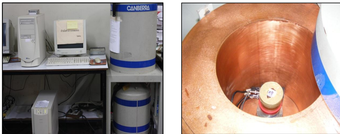
ภาพประกอบ 3.1 ชุดระบบวัดรังสีแกมมา ชนิดหัววัดแบบ HPGe
