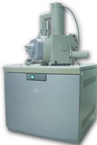
รูปที่ 3.6 กล้องจุลทรรศน์อิเล็กตรอนแบบส่องกราด
