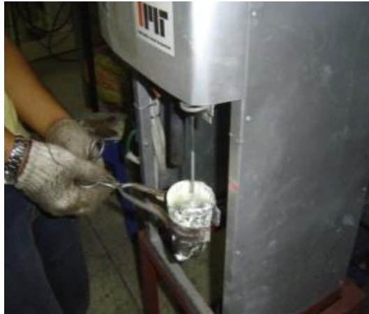
รูปที่ 3.5 แสดงการปล่อยฟองแก๊สในน้ำโลหะกึ่งของแข็งผ่านแท่งกราไฟต์พอร์น
