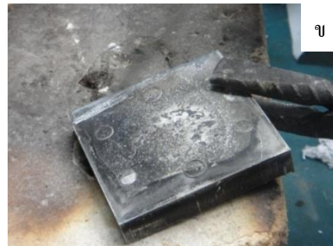
รูปที่ 3.6 (ก) แสดงแม่พิมพ์ขณะอัดขึ้นรูป (ข) แสดงแผ่นอะลูมิเนียมเกรด 7075 ขนาด 10 x 10 x 1.5 เซนติเมตร
