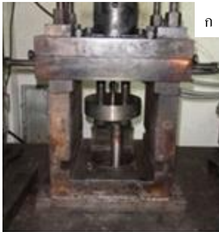
รูปที่ 3.4 (ก) แสดงการติดตั้งแม่พิมพ์บนเครื่องอัดไฮดรอลิก (ข) แสดงการอุ่นแม่พิมพ์ให้ร้อนด้วย Heater ให้ความร้อน
