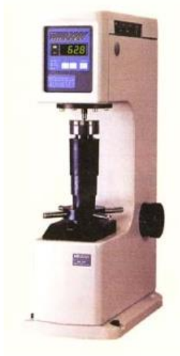
รูปที่ 2.12 หลักการทดสอบความแข็งรีดิวซ์สเกล B (ASTM E18-08b) [17]
