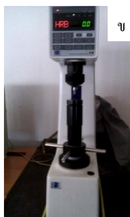
รูปที่ 3.10 (ก) แสดงระยะห่างในการวัดค่าความแข็งของชิ้นงานในแต่ละจุด (ข) เครื่องวัดความแข็งแบบร็อกเวลล์สเกลบี
