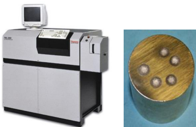
รูปที่ 2.27 แสดงเครื่อง Optical Emission Spectrometer และชิ้นงานที่ได้จากการวิเคราะห์ [25]
