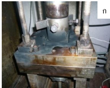
รูปที่ 3.6 (ก) แสดงแม่พิมพ์ขณะอัดขึ้นรูป (ข) แสดงแผ่นอะลูมิเนียมเกรด 7075 ขนาด 10 x 10 x 1.5 เซนติเมตร
