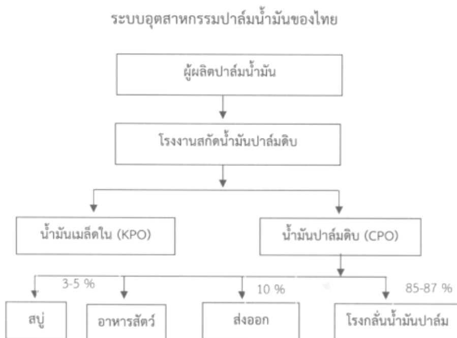
Figure 4 System of oil palm extraction of Thailand ที่มา : ดัดแปลงจาก ชีระ เอกสมทราเมษฐ์ และคณะ (2546)
