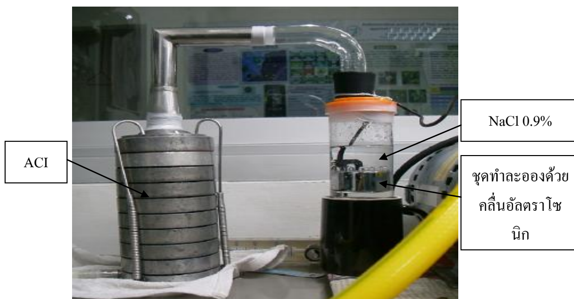
รูปที่ 3-3 ชุดทดลองเพื่อเตรียมสารสำหรับการวัดขนาดละอองที่ได้จากการ nebulization
